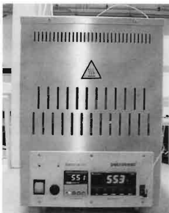
รูปที่ 2.4 ฉ. เครื่องวิเคราะห์หาปริมาณกากคาร์บอนของแร่มส์บอตตอม (Ramsbottom Carbon Residue Test, ASTM D 524)
