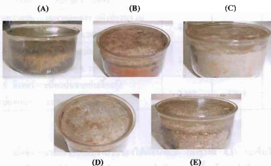
ภาพที่ 4.2 ลักษณะของดินที่ใช้เลี้ยงไส้เดือนทะเลเพื่อศึกษาอิทธิพลของประเภทดินต่อการเจริญเติบโตของไส้เดือนทะเลในครอบครัว Capitellidae (A: ดินโคลนเหลว, B: ดินโคลนปนทราย, C: ดินโคลนเหนียวเนื้อละเอียด, D: ดินทรายปนโคลน, E: ดินทราย)
