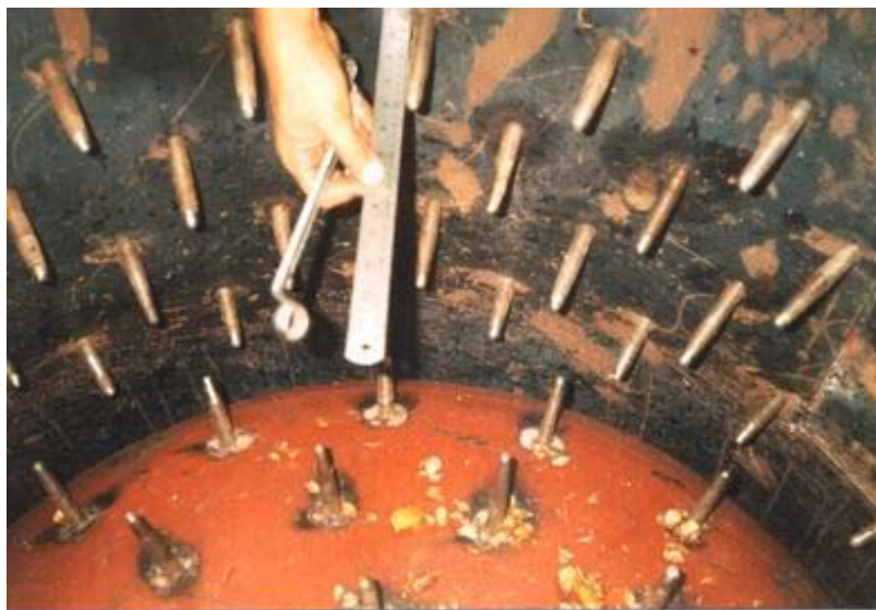
รูปที่ 3.2 แสดงการปรับความยาวของเคียวแซะผลปาล์มจากทะเลาย
