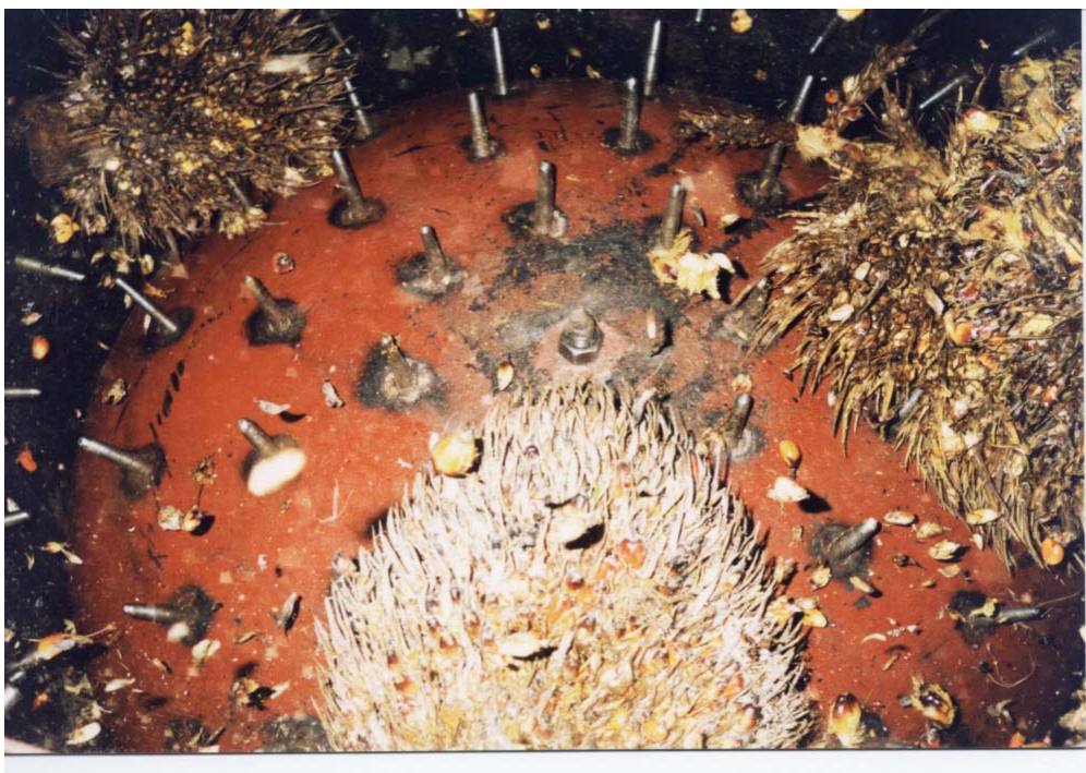
รูปที่ 3.5 แสดงการหมุนเหวี่ยงของทะลายปาล์มในขณะที่อยู่ในเครื่องแยกผล
