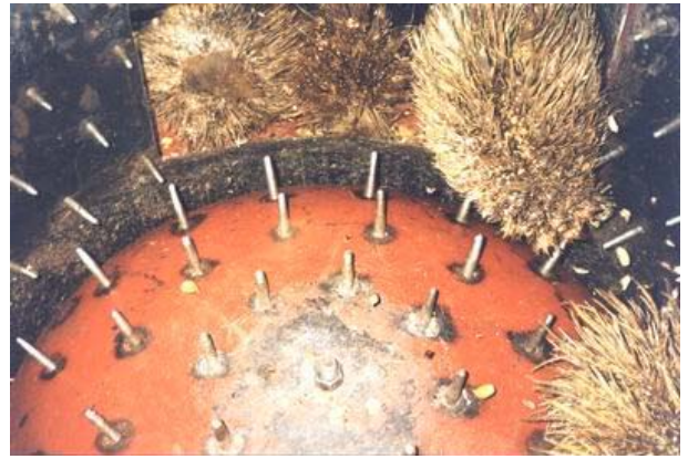
รูปที่ 6 แสดงทะลายที่เหลือแต่ซึ่งขณะกำลังถูกเหวี่ยงออกที่ประตูทางออกซึ่งปาล์ม
