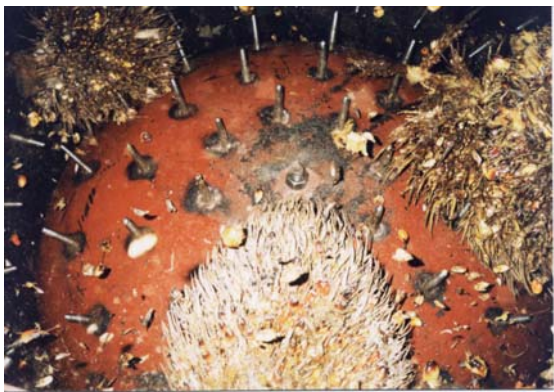
รูปที่ 5 แสดงการหมุนเหวี่ยงของทะลายปาล์มในขณะที่อยู่ในเครื่องแยกผล
