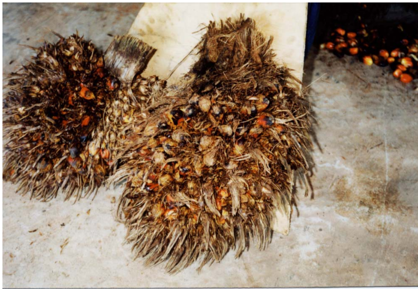
รูปที่ 3.11 แสดงลักษณะทะลายน้ำมันที่เข้าเครื่องแยกโดยไม่ได้บ่มเข้าเครื่องแยกเป็นเวลา 3 นาที
