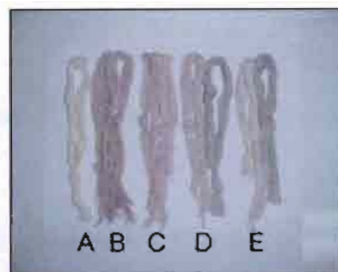
รูปที่ 8.5 ด้ายฝ้ายที่ชุบในสารสีสกัดจากแบคทีเรียเป็นเวลา 3 ชั่วโมง (A) ด้ายฝ้ายที่ไม่ชุบมอร์แดนท์ (B,D) ด้ายฝ้ายที่ชุบกรดแทนนิกก่อนย้อม และ (C,E) ด้ายฝ้ายที่ชุบสารสั้มก่อนย้อม
