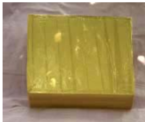
รูปที่ ก.41 พิมพ์ที่ถูกปิดทับด้วยเทปกาว
