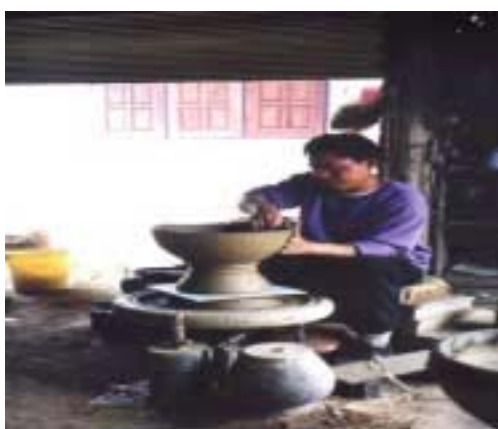
รูปที่ ก.17 การปั้นโดยใช้แป้นหมุนเดียว
