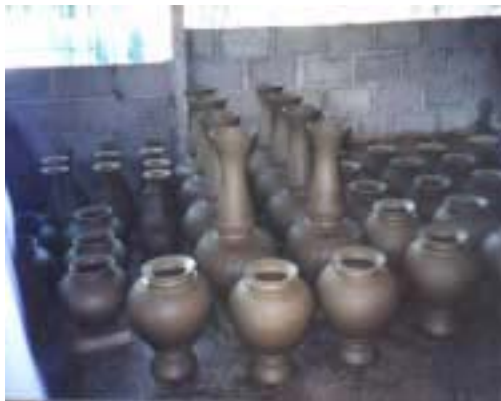
รูปที่ ก.21 ชิ้นงานรอให้หมาดเพื่อลงสีดินแดง ขัดเงา
