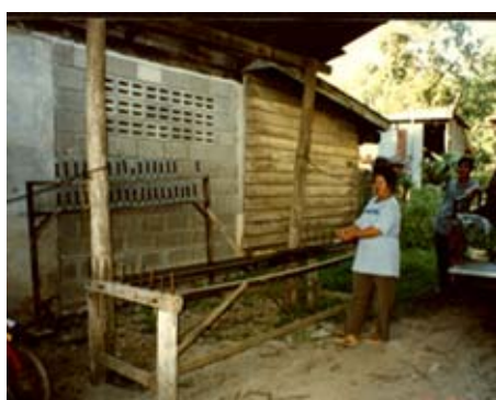
รูปที่ ก.11 เฝียขอที่ใช้ในการไว้นหรือเดินเส้น ของด้ายยืน
