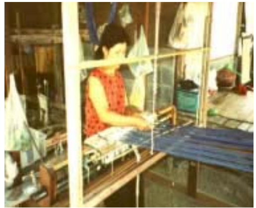
รูปที่ ก. 20 การต่อเครื่องเก่าบนกี่เมือง
