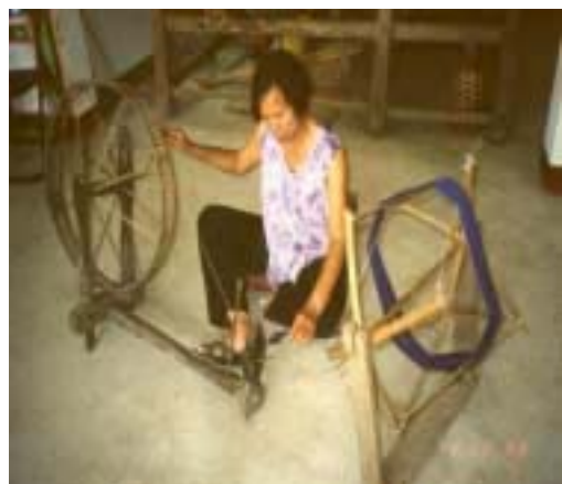
รูปที่ ก.16 การกรอฝ้ายเส้นพุ่ง ใส่หลอดกระสวย
