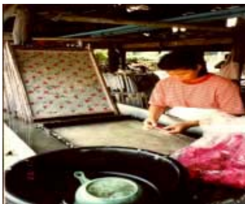
รูปที่ ก. 27 การตะดอกไม้ลงในเฟรมที่ทำการ ตะสาไว้แล้ว
