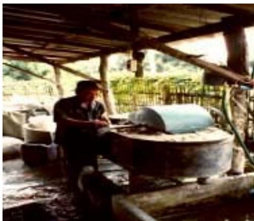
รูปที่ ก. 23 การตีสาด้วยเครื่องมือสา
