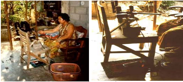
รูปภาพที่ 5.1 เครื่องกรอผ้าแบบเท้าเหยียบโดยใช้มอเตอร์ไฟฟ้า
