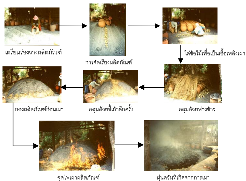
รูปภาพที่ 5.14 วิธีการเผาของกลุ่มเครื่องปั้นดินเผาบ้านม่อนเขาแก้ว
