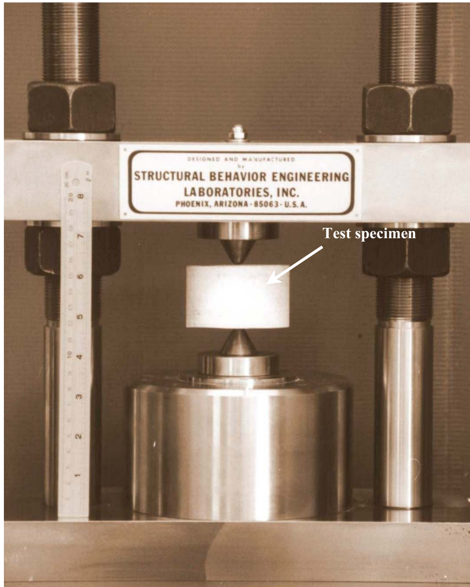
รูปที่ 4.26 การทดสอบจุดกดแบบดั้งเดิม (Conventional point load testing) ตัวอย่างหินอ่อนรูปทรงกระบอกถูกกดตามแนวแกนด้วยเครื่อง SBEL PLT-75
