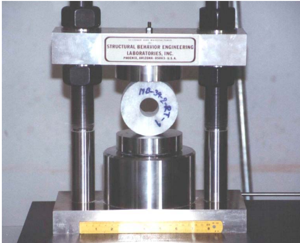
รูปที่ 4.41 การทดสอบแรงดิ่งแบบวงแหวน ตัวอย่างหินอ่อนถูกกดตามแนวเส้นผ่าศูนย์กลาง
