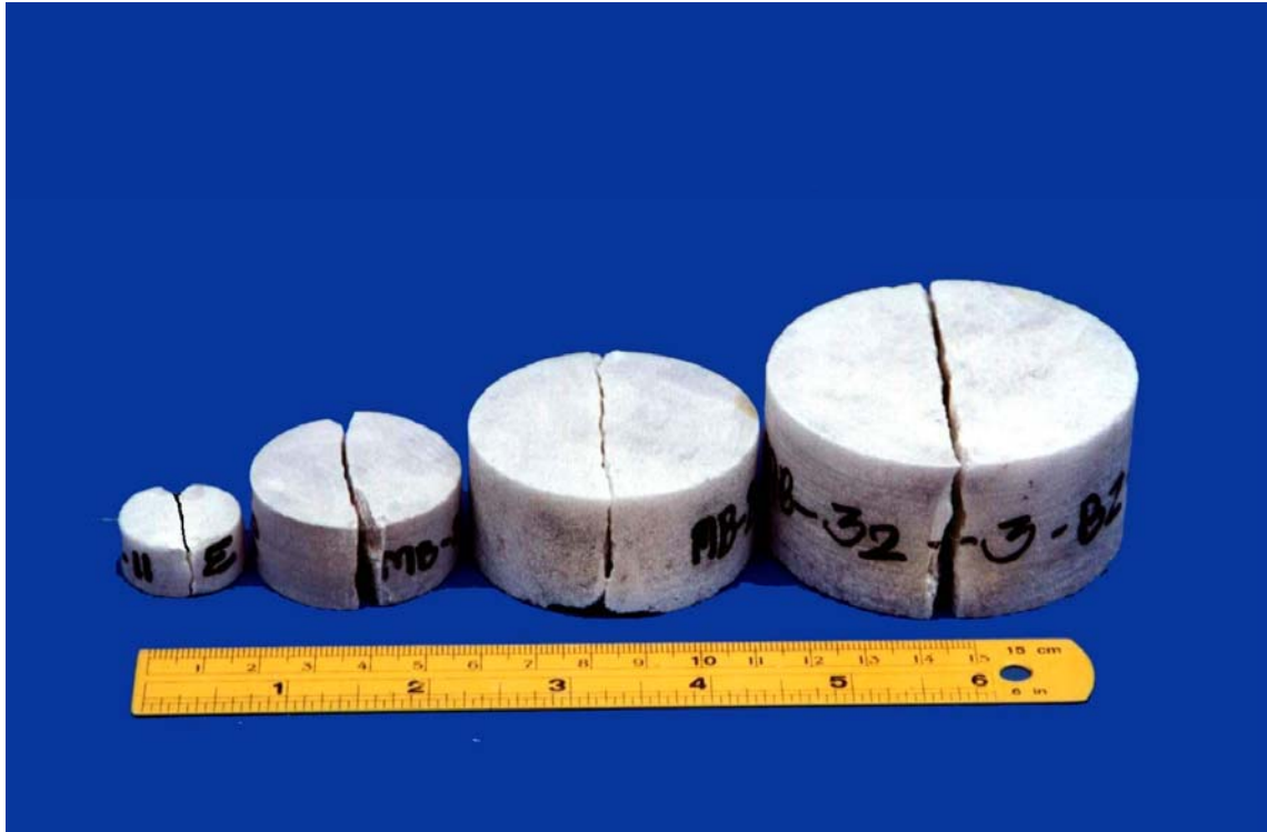
รูปที่ 4.23 บางส่วนของหินตัวอย่างในหลายขนาดซึ่งได้ทดสอบแบบบราซิล แล้วหินตัวอย่างมีการแตกตามแนวเส้นผ่าศูนย์กลาง หรือตามแนวการกด
