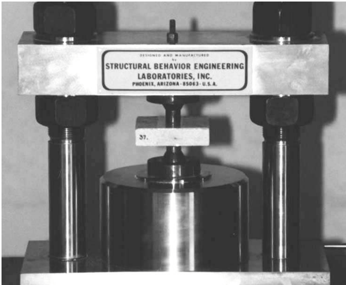
รูปที่ 4.35 ตัวอย่างของหินอ่อนรูปแผ่นสี่เหลี่ยมจัตุรัสถูกกดที่จุดกึ่งกลางของแผ่นในการทดสอบจุดกดแบบปรับเปลี่ยน
