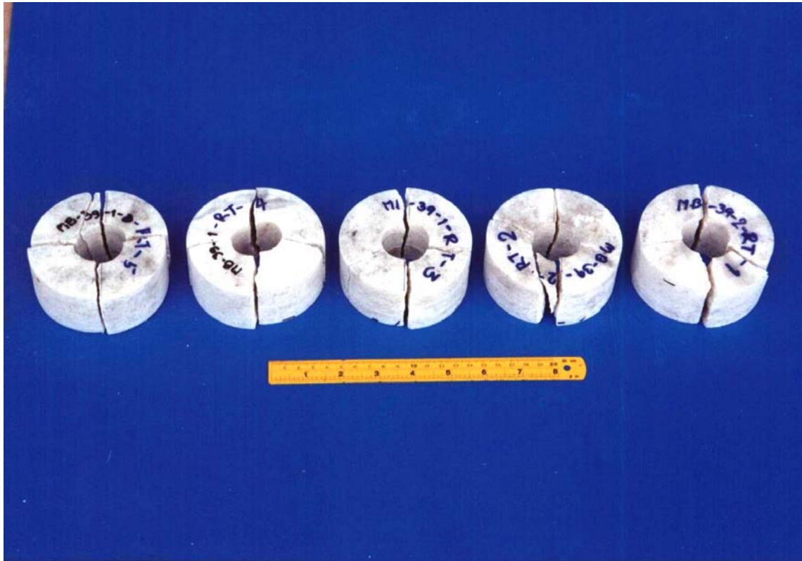
รูปที่ 4.42 ตัวอย่างหินอ่อนแบบวงแหวนมีการแตกตามแนวเส้นผ่าศูนย์กลาง หรือตามแนวคด
