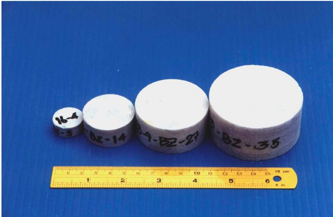
รูปที่ 4.21 ตัวอย่างของหินอ่อนบางส่วนที่มีขนาดต่างกัน แต่ L/D คงที่เท่ากับ 0.5 ถูกจัดเตรียมขึ้นเพื่อทดสอบแบบบราซิล
