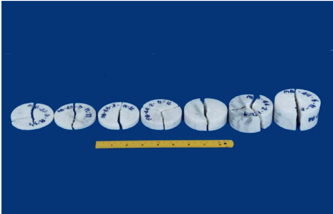
รูปที่ 4.27 ตัวอย่างหินอ่อนที่มีความหนาต่างกัน หลังจากถูกทดสอบโดยการกดให้แตกโดยใช้วิธี จุดกดแบบดั้งเดิม
