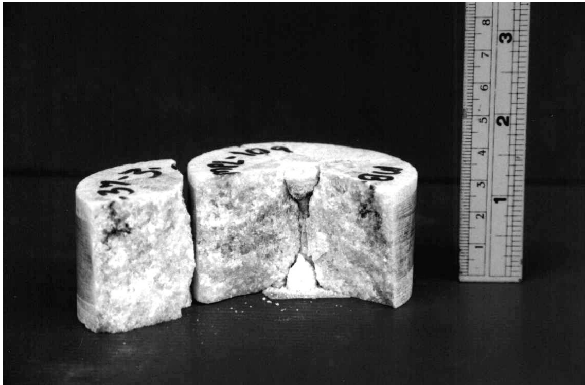
รูปที่ 4.37 ตัวอย่างหินรูปแผ่นกลมถูกกดแตกโดยมีการแตกเป็นรูปกรวยที่บริเวณภายใต้หัวกด ซึ่งแสดงให้เห็นว่าหินแตกแบบความกดเฉือน (Compressive shear failure) ในบริเวณนี้
