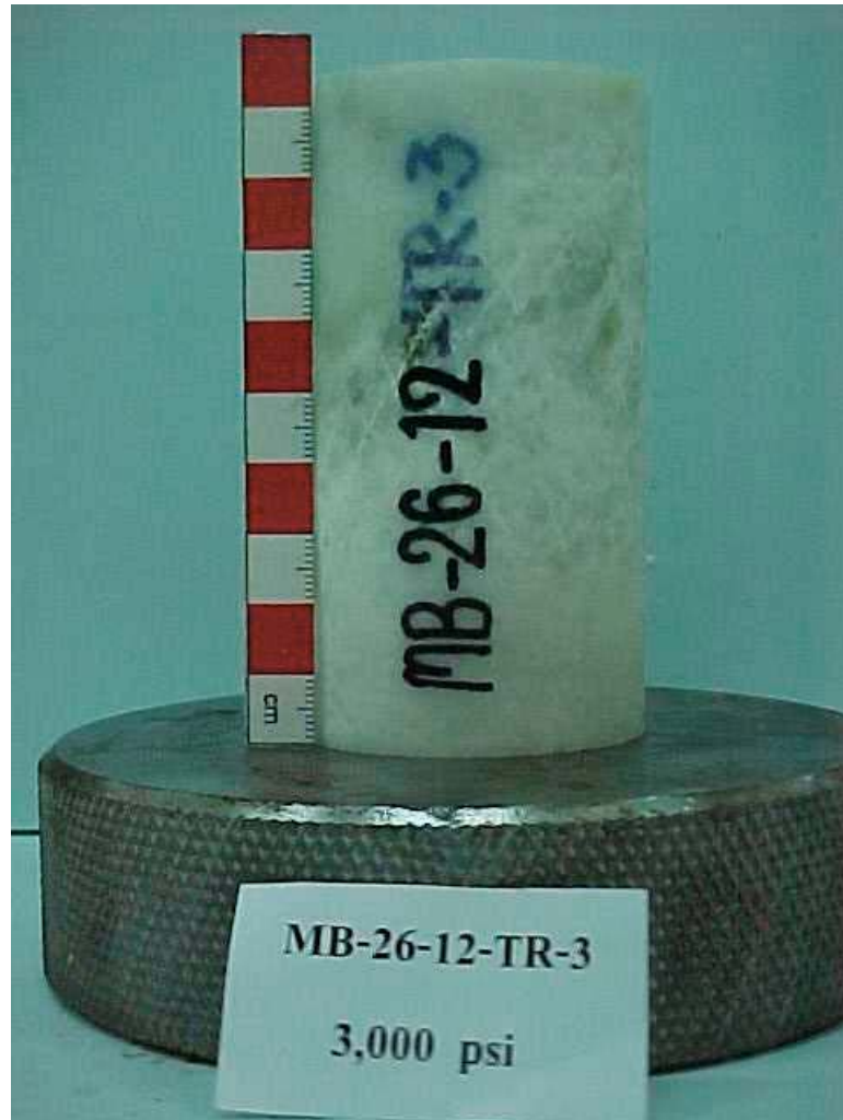
รูปที่ 4.30 การแตกร้าวของตัวอย่างหินอ่อนที่ความดันล้อมรอบ ( \sigma_3 ) เท่ากับ 3000 psi ของ Sample No. MB-26-12-TR-3
