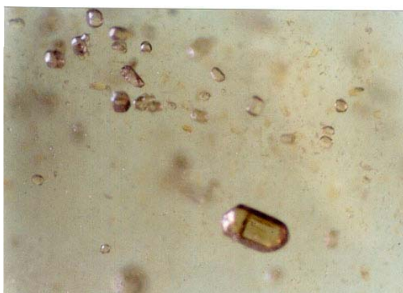
มลทินผลึกแร่อะพาไทต์ และมลทินผลึกกลาง (Negative Crystal; 45x)
