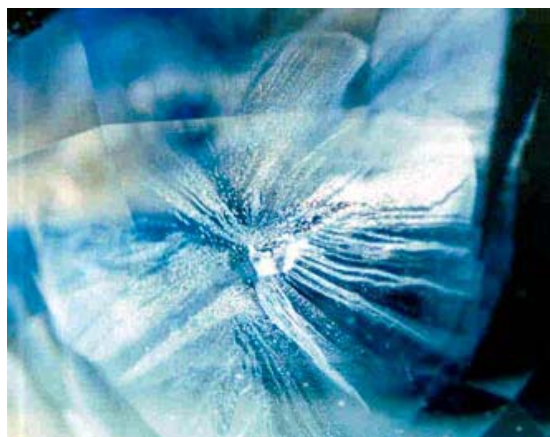
รอยแตกที่ถูกสมานด้วยของไหล และร่องรอยที่ถูกแรงอัด (Stress fracture: 30x)
