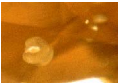
(ข) ผลึกแร่เซอร์คอน ล้อมรอบด้วย รอยแตก รูปร่างคล้ายแผ่นจาน (50X)
