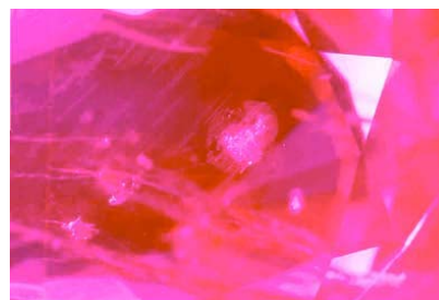
(ข) มลทินผลึกแร่มีรอยแตกรูปร่างคล้ายแผ่นจาน ล้อมรอบผลึกแร่เซอร์คอน และสายของ มลทินของไหล (25X)
