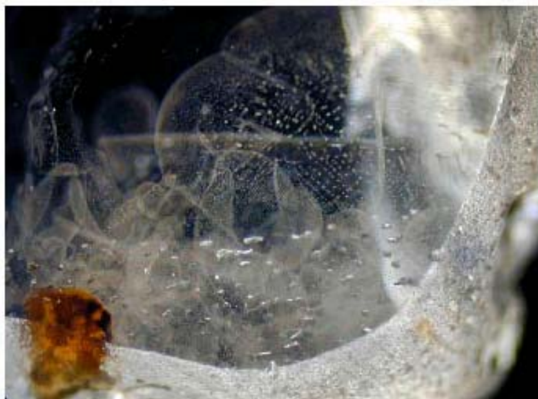
รูปที่ 3.21 มลทินรอยแตกสมานรูปรอยนิ้วมือ (fingerprint-like healed fractures) มลทินผลึกกลวงที่เรียงตัวไปตามรอยแตกสมาน และเหล็กออกไซด์ สีน้ำตาลเหลือง พบในพลอยกลุ่มสีน้ำเงิน (SPI-B)
