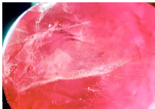
(ข) รอยแตกที่ถูกสมานด้วยของไหล และ ผลึกเข็มยาวของแร่เบอห์ไมต์ (30X)
