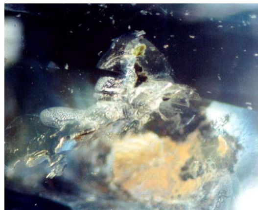
รอยแตกที่ถูกสมานด้วยของไหล (Healing Fracture 70x)
