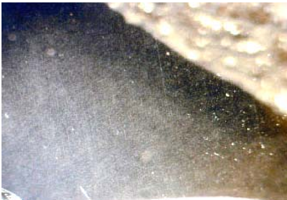
รูปที่ 3.32 มลทินเชื่อมยาวของแร่รูไทล์ พบในกลุ่มพลอยไร้สี SPI-CL)
