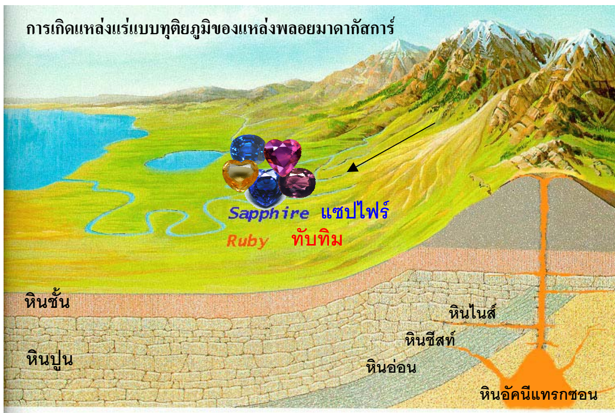
รูปที่ 1.4 พลอยแซปไฟร์หลุดออกมาจากเนื้อหินต้นกำเนิดที่ผุพังถูกพัดพาลงมาโดยทางน้ำ และมารวม สะสมตัวในที่ลุ่ม เกิดเป็นแหล่งแร่แบบทุติยภูมิหรือแบบลานแร่ เช่น แหล่งพลอยในทูลีเยร์
