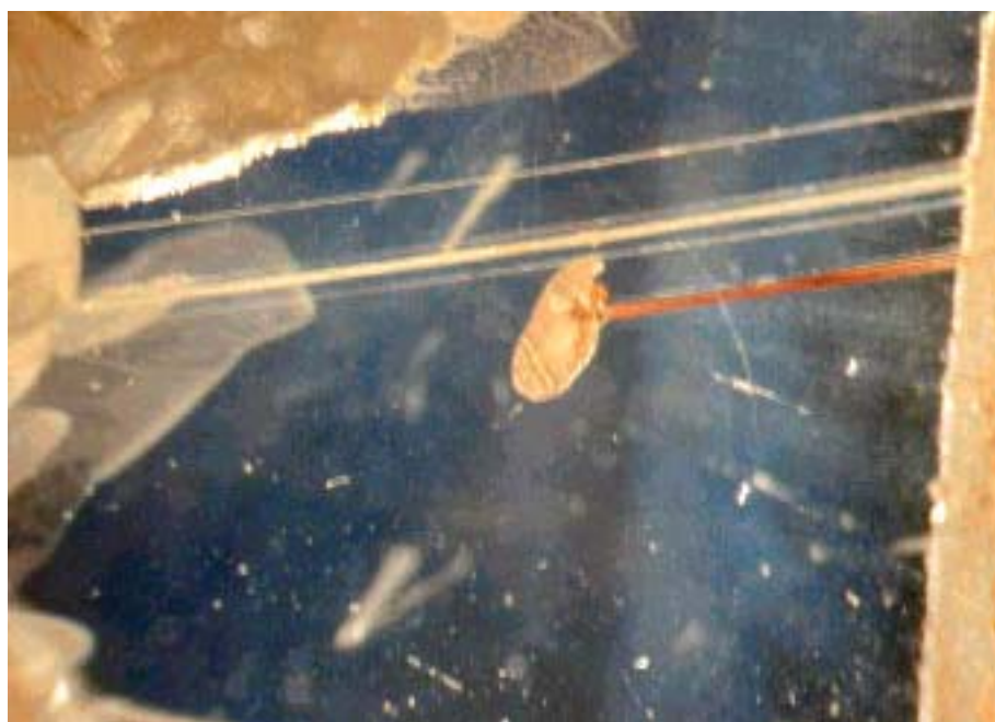
รูปที่ 3.33 มลทินท่อกวาง ในบางส่วนของท่อจะมีเหล็กออกไซด์สีน้ำตาลแดงบรรจุอยู่
