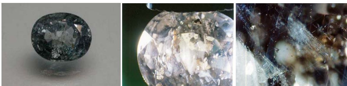
(ก) ลักษณะปรากฏของตัวอย่างแซปไฟร์ (ข) มลทินผลึกแร่เซอร์คอน และแร่อะพาไทต์ (2X) (ค) มลทินคล้ายฝุ่น ผลึกเข็มยาว ตัดกัน (7X)
