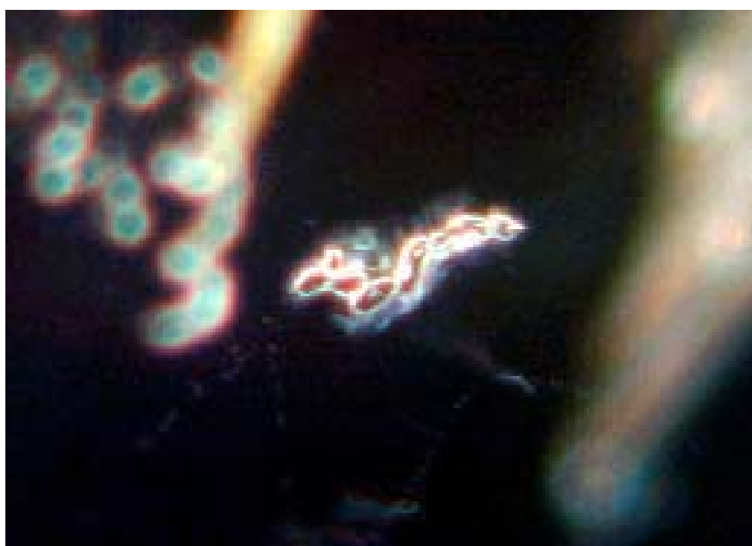
รูปที่ 3.25 มลทินผลึกแร่แพทายที่มีลักษณะขอบมน อยู่รวมกันเป็นกลุ่ม พบในพลอยกลุ่มสีม่วง (SPI-V)
