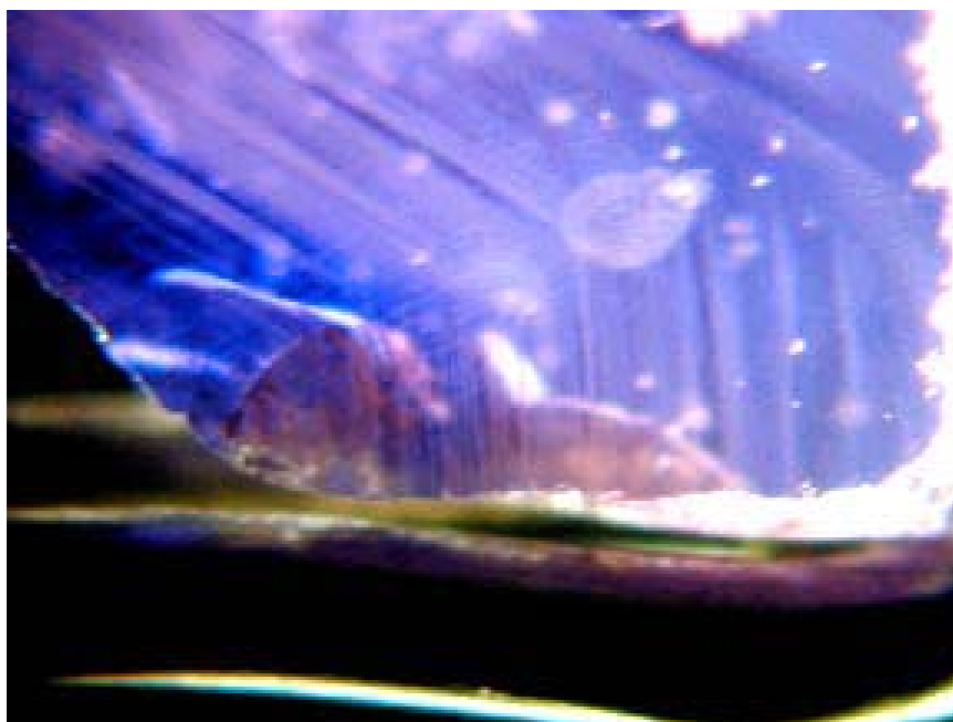
รูปที่ 3. 26 ตัวอย่างพลอยอิลากาในกลุ่มสีม่วง (SP-V) ที่แสดงแนวการเจริญเติบโตของผลึกพลอย ทำมุม 120 องศา
