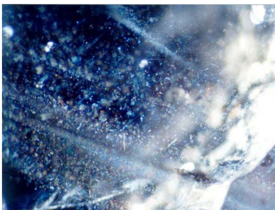
มลทินผลึกเข็มขนาดเล็ก และเข็มแท่งสั้น กระจายอยู่ทั่วไป (30x)
