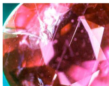
(ข) รอยแตกที่ถูกสมานด้วยของไหล ผลึกเข็มยาวของแร่เบอห์ไมต์ (40X)
