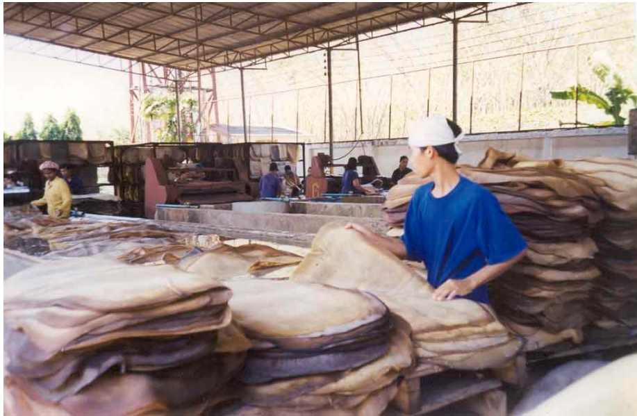
รูปที่ 3.3 การนำยางลบ่อแช่ก่อนลอกด้วยพนักงาน
