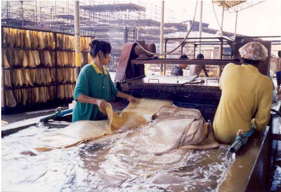
รูปที่ 3.5 พนักงานนำยางที่ลอกแล้วเข้ากระบวนการล้าง
