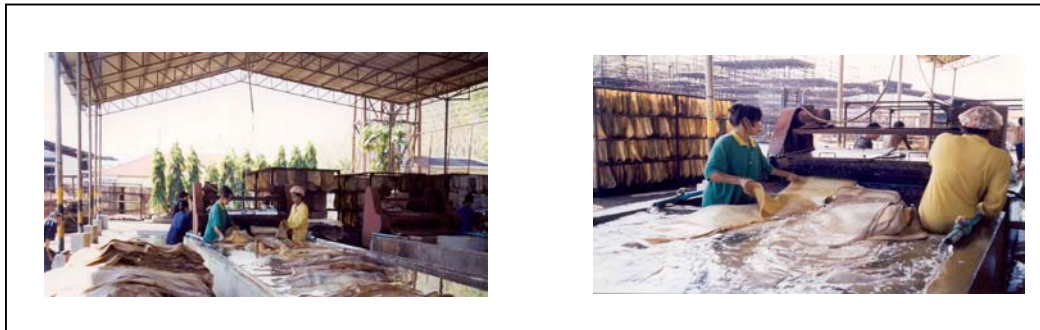
รูปที่ 1 กระบวนลอกและล้างยางในโรงงานอุตสาหกรรม
