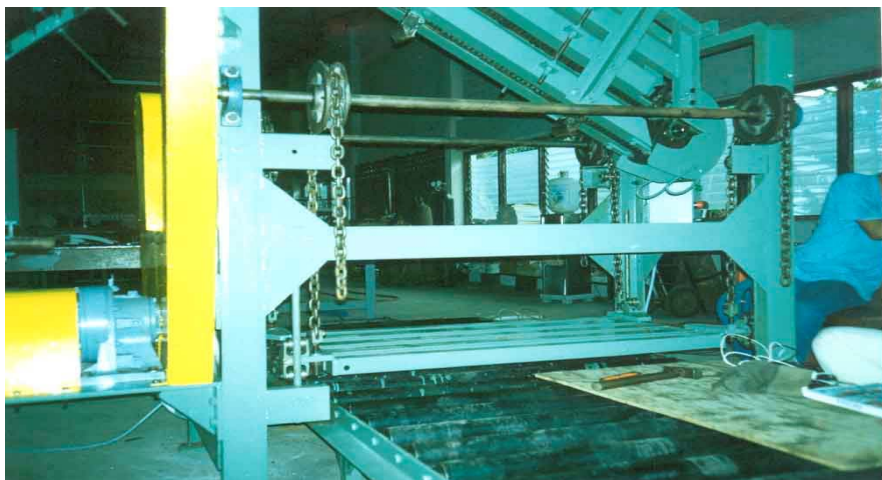
รูปที่ 3.14 ชุดป้อนและยกยาง (Lift and Feed Unit)
