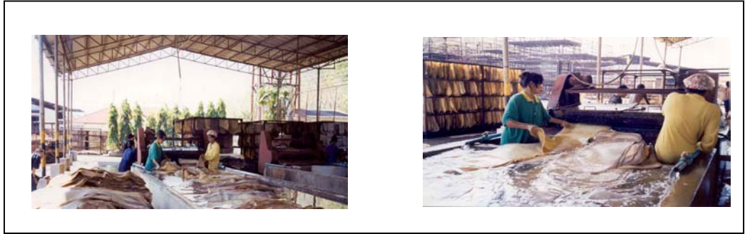
รูปที่ 1 กระบวนการลอกและล้างยางในโรงงานอุตสาหกรรม
