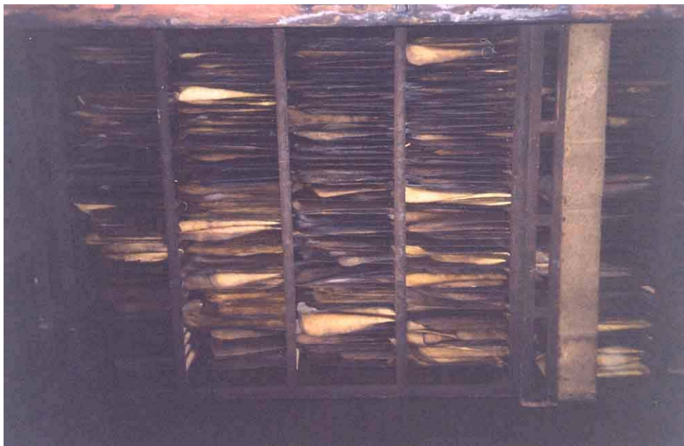
รูปที่ 3.8 การนำแผ่นยางที่ผ่านการตากแล้วนำเข้าโรงรมควันเพื่ออบแห้ง
