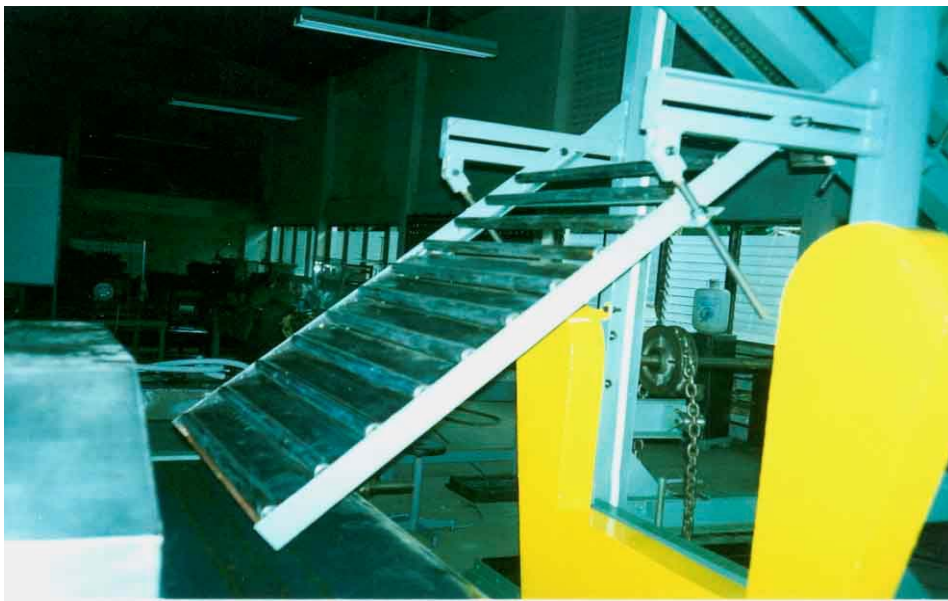
รูปที่ 3.15 ชุดรับยางลำเลียงลงสู่สายพานลำเลียง (Roller Feed Unit)
