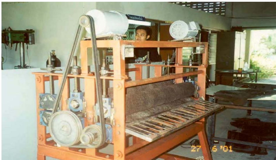
รูปที่ 3.11 ชุดล้างยาง (Washing Unit)
