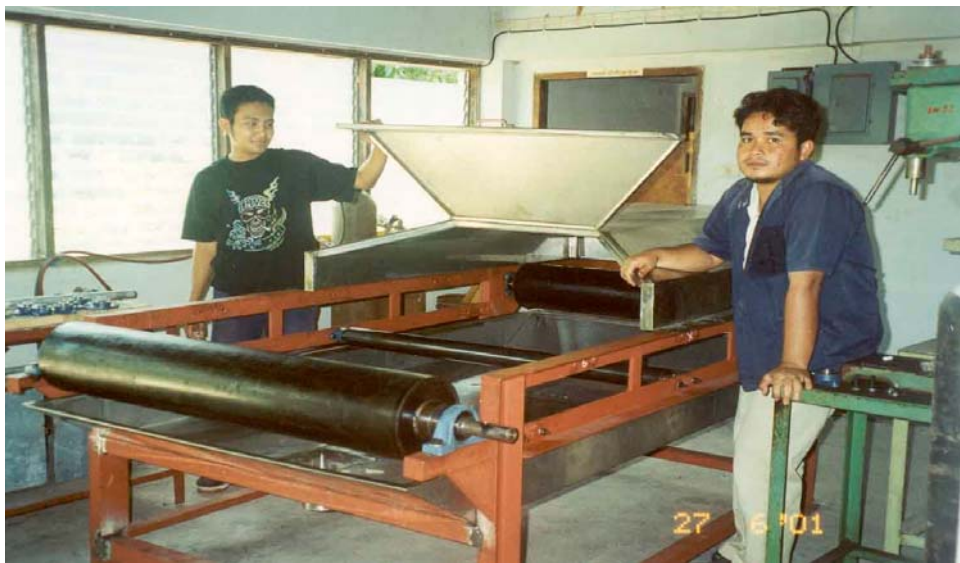
รูปที่ 3.12 ชุดสายพานป้อนยาง (Rubber feed Unit)
