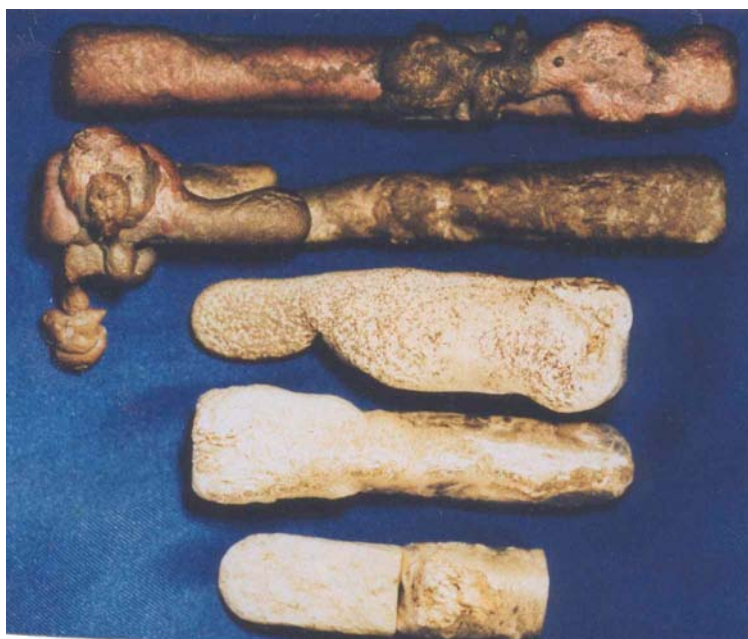
รูปที่ 5.4 ผลของปริมาณแคลเซียมซิลิไซด์ต่อผิวงานหล่อ เมื่อเวลาหลอมโลหะเท่ากับ 0 นาที (เทโลหะทันทีหลังจากกวน) โดยปริมาณแคลเซียมซิลิไซด์เรียงจากบนลงล่าง คือ 0.1, 0.2, 0.3, 0.5 และ 1.0% โดยน้ำหนัก ตามลำดับ
