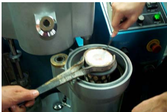
รูปที่ 4.5 การหล่อโลหะลงกระบอกลูกปืนโดยใช้ระบบดูดสุญญากาศ
