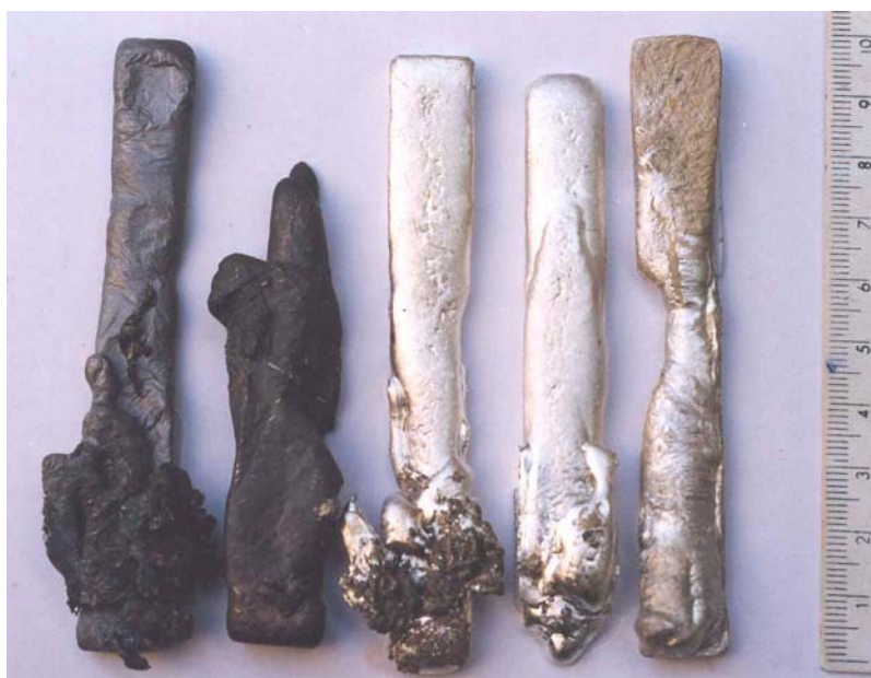
รูปที่ 5.4 ผลของปริมาณแคลเซียมซิลิไซด์ต่อผิวงานหล่อ เมื่อเวลาหลอมโลหะเท่ากับ 0 นาที (เทโลหะทันทีหลังจากกวน) โดยปริมาณแคลเซียมซิลิไซด์เรียงจากบนลงล่าง คือ 0.1, 0.2, 0.3, 0.5 และ 1.0% โดยน้ำหนัก ตามลำดับ
