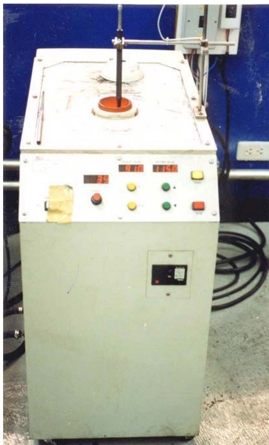
รูปที่ 4.1 เตาอินดักชันและอุปกรณ์พร้อมเครื่องระบายความร้อนแบบไหลเวียนภายใน
