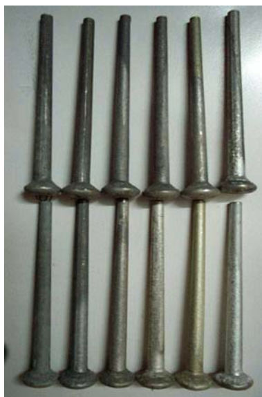
รูปที่ 5.1 ชิ้นงานหล่อเงินผสมทองแดง โดยใช้เครื่องหล่อดูดสุญญากาศ ปริมาณซิลิกอนที่เติมเข้าไป จากซ้ายไปขวาเพิ่มขึ้นตั้งแต่ 0, 0.1, 0.2, 0.3, 0.4 และ 0.5 % โดยน้ำหนัก และชิ้นงาน (แนวบน) เกรด 925 และชิ้นงาน (แนวล่าง) เกรด 950 ตามลำดับ
