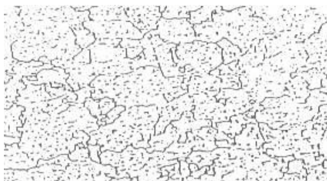
รูปที่ 1.2 แสดงโครงสร้างจุลภาคของเงินสเตอร์ลิง
