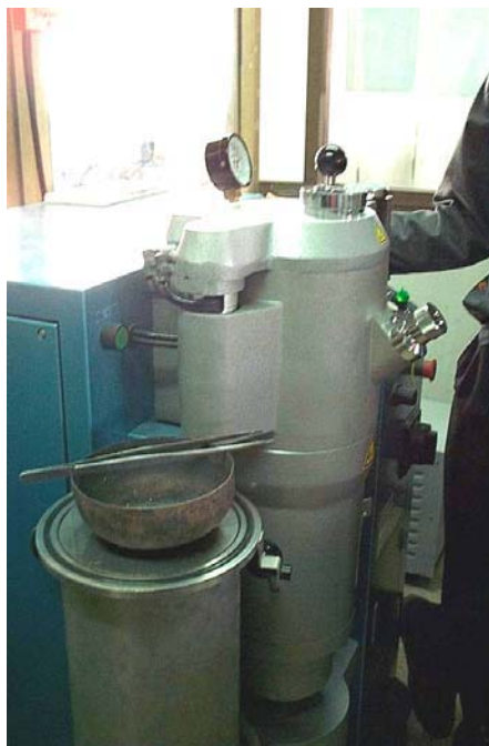
รูปที่ 4.2 เตาหลอมโลหะอินดักชันภายใต้ระบบสุญญากาศ
