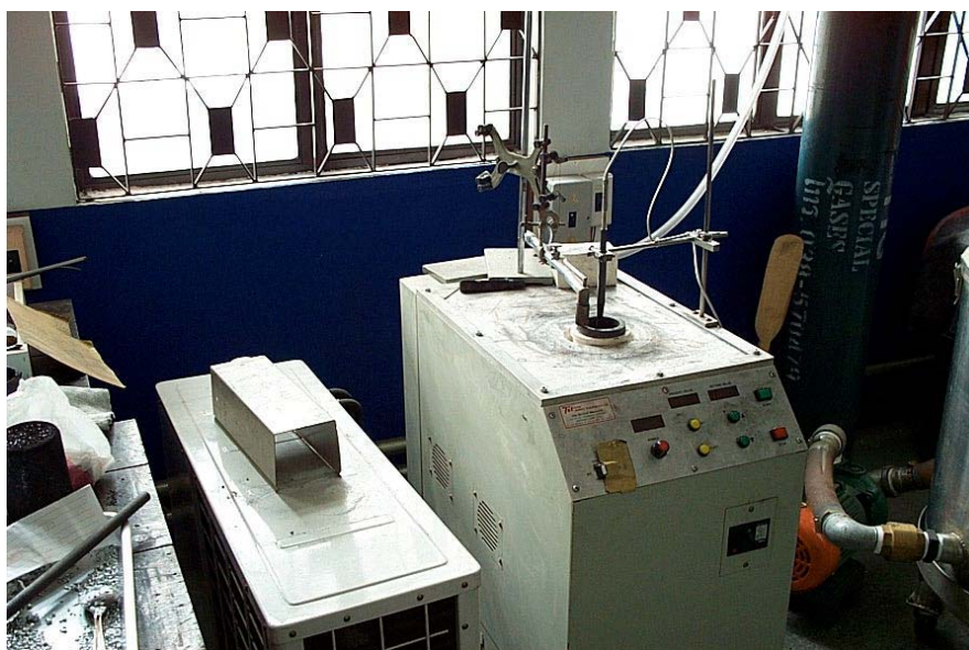
รูปที่ 3.8 เตาอินดักชั่นและอุปกรณ์ที่ใช้สำหรับหล่อเงินสเตอร์ลิง
