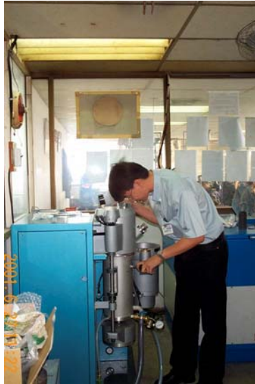
รูป 3.11 เครื่องหล่อด้วยสุญญากาศที่มีระบบกวนน้ำโลหะที่ใช้ในวงการอุตสาหกรรมเครื่องประดับ
