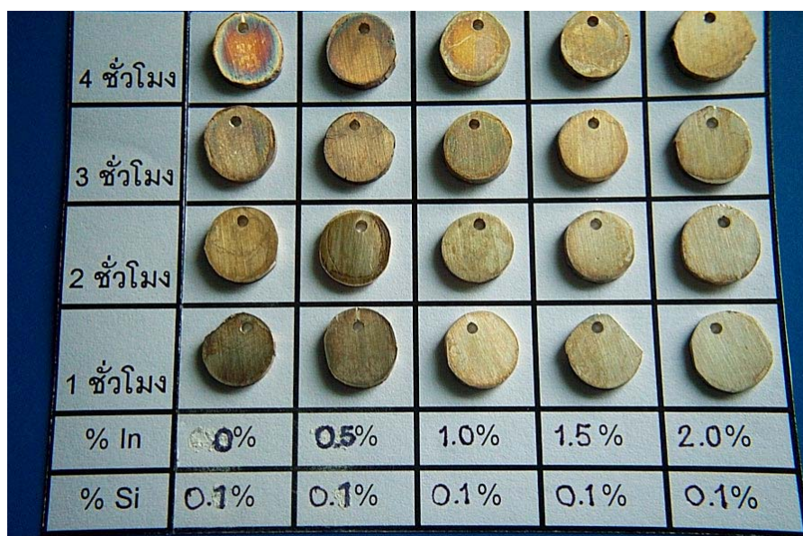
รูปที่ 3.29 ภาพถ่ายแสดงสีผิวชิ้นงานหล่อเงินสเตอร์ลิงที่มีปริมาณของซิลิคอนใกล้เคียงกัน (0.09 - 0.11% wt. ) แต่มีปริมาณของอินเดียมแตกต่างกันได้แก่ 0, 0.5, 1, 1.5 และ 3.0 % wt.(มีอยู่จริงในชิ้นงาน 0, 0.53, 1.09, 1.60 และ 3.13 % wt.ตามลำดับ)โดยใช้เวลาทดสอบ 1, 2, 3 และ 4 ชม.
