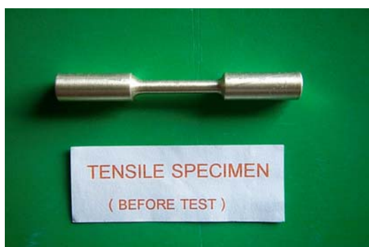
รูปที่ 3.14 รูปชิ้นงานทดสอบความต้านทานแรงดึง ก่อนและหลังผ่านการทดสอบ
