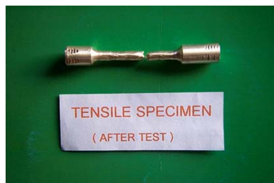
รูปที่ 3.14 รูปชิ้นงานทดสอบความต้านทานแรงดึง ก่อนและหลังผ่านการทดสอบ
