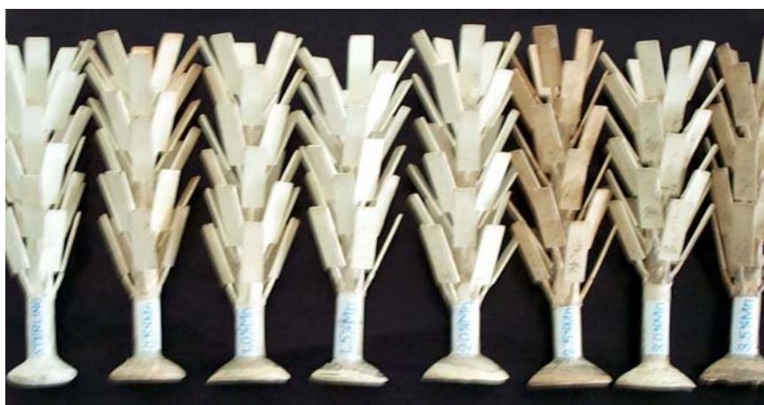
รูปที่ 4.16 ภาพแสดงชิ้นงานที่ได้จากการหลอมและหล่อแบบสุญญากาศ ของโลหะเงินสเตอร์ลิงที่เติมปริมาณแมงกานีส 0, 0.5, 1.0, 1.5, 2.0, 2.5, 3.0 และ 3.5 เปอร์เซ็นต์โดยน้ำหนัก
