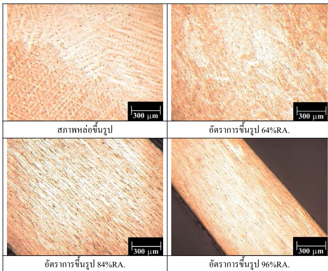
ภาพที่ 2-34 โครงสร้างจุลภาคของโลหะเงิน 0.023P 5.289Cu 94.688Ag ที่สภาพต่างๆ
