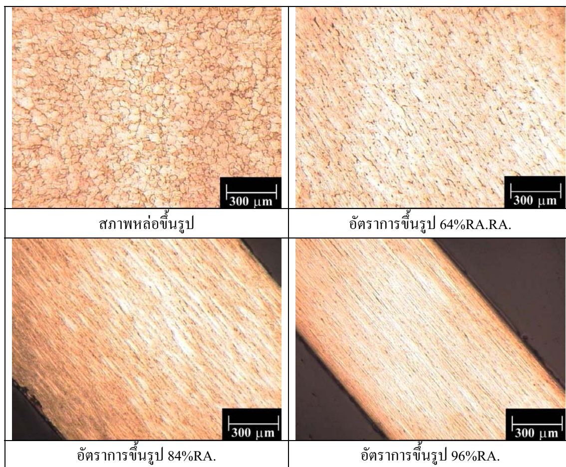
ภาพที่ 2-38 โครงสร้างจุลภาคของโลหะเงิน 0.074P 0.997In 5.700Cu 93.229Ag ที่สภาพต่างๆ
