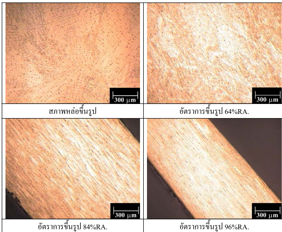
ภาพที่ 2-32 โครงสร้างจุลภาคของโลหะเงิน 0.009P 5.550Cu 94.441Ag ที่สภาพต่างๆ
