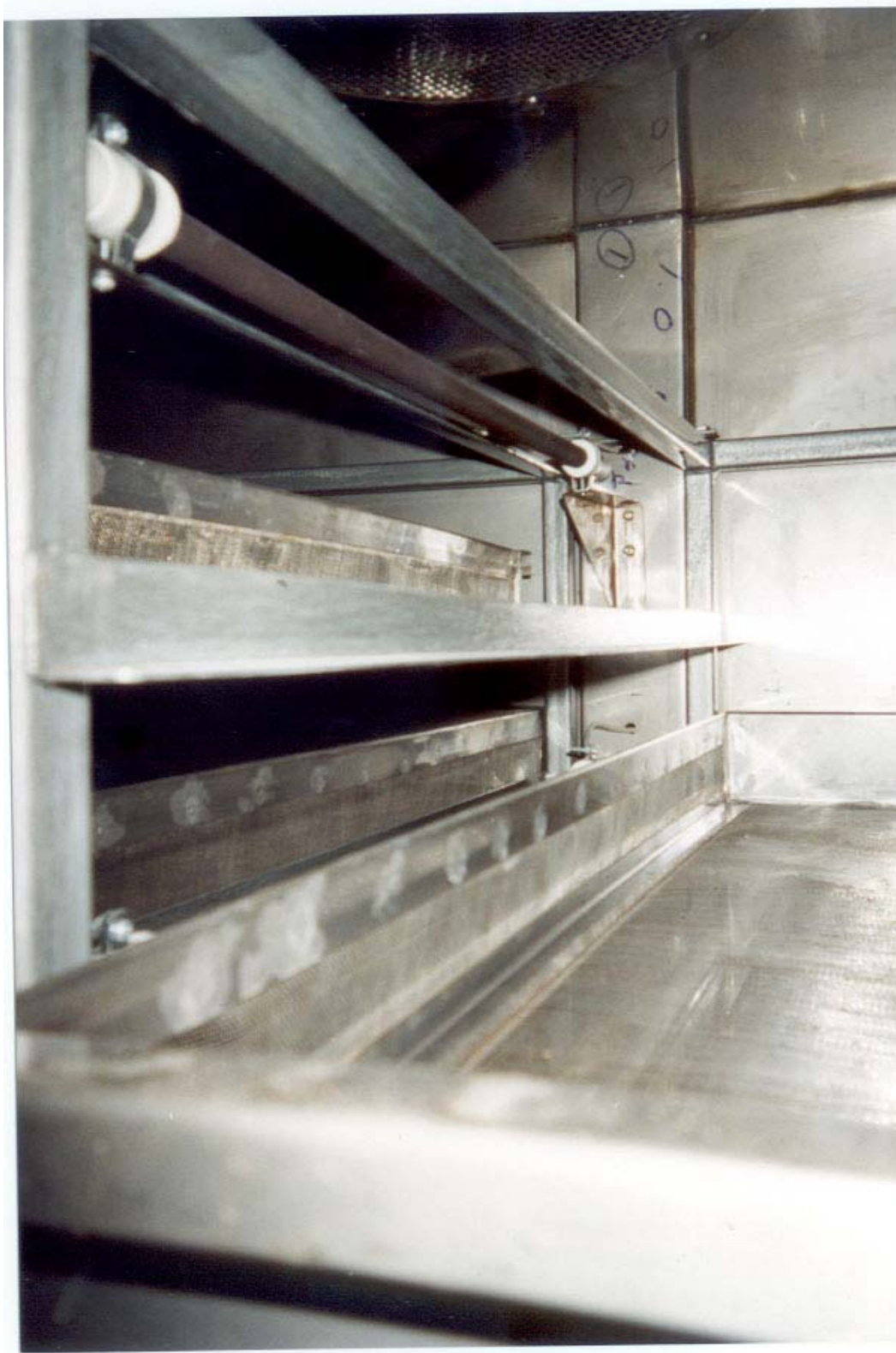
ภาพที่ 16 หลอดอินฟราเรดภายในตู้อบ
