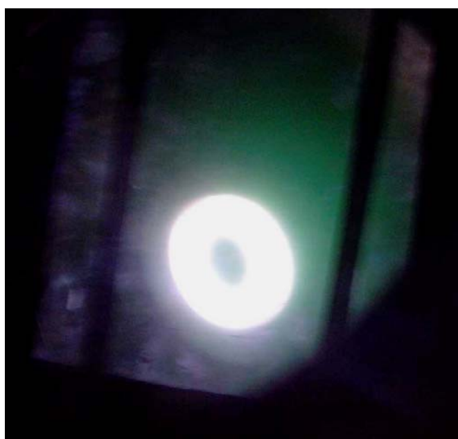
รูปที่ 6.22 วงแหวนพลาสมาที่เกิดขึ้นที่หน้าเป้าสารเคลือบ
