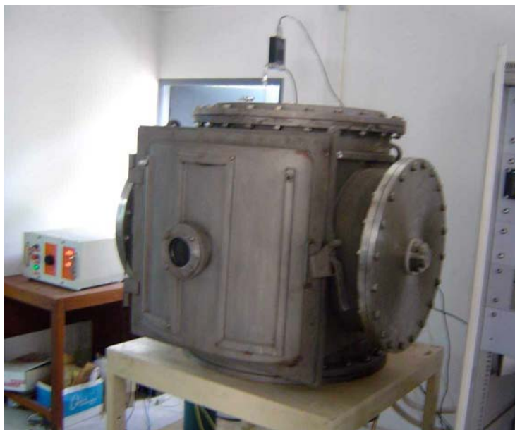
รูปที่ 6.19 แสดงภาชนะสุญญากาศขณะทำการเคลือบฟิล์ม
