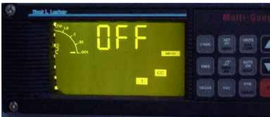
รูปที่ 6.13 หน้าจอของช่องวัดความดันของ Cold cathode Gauge ที่อยู่ในสถานะปิด (OFF)
