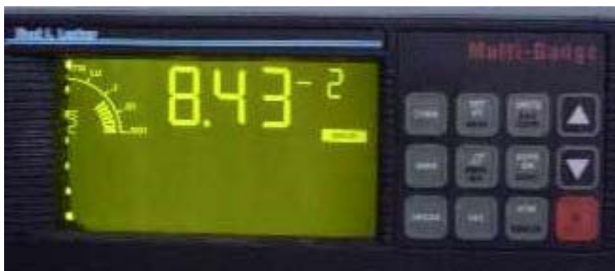
รูปที่ 6.6 ค่าความดันที่วัดได้จาก Convectron Gauge ที่ติดตั้งกับภาชนะสุญญากาศ
