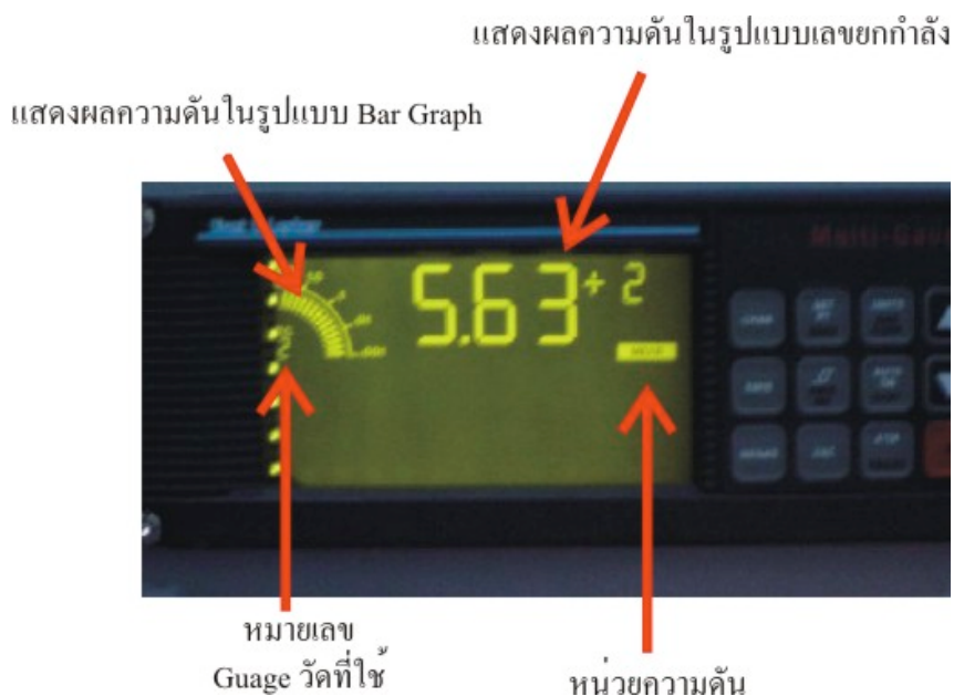
รูปที่ 5.16 รายละเอียดของส่วนต่างของหน้าจอแสดงผลของ Multi-Gauge Controller
