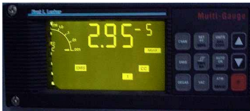
รูปที่ 6.15 ค่าความดันที่วัดได้หลังจากที่ Cold cathode Gauge ทำงานแล้ว
