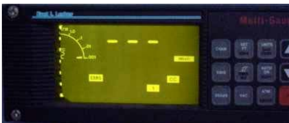
รูปที่ 6.14 หน้าจอของช่องวัดความดันของ Cold cathode Gate หลังจากกดปุ่ม EMIS
