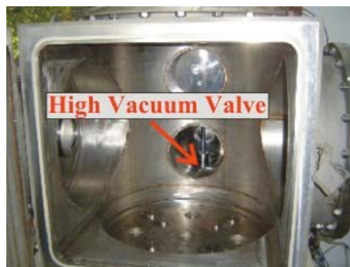
รูปที่ 5.7 High Vacuum Valve
