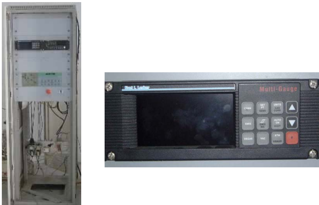
รูปที่ 5.14 Multi-Gauge Controller
