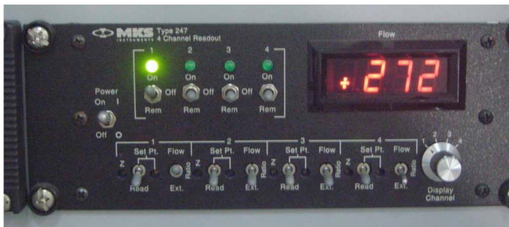
รูปที่ 6.17 แผงควบคุมของ MKS Type 247 Four-Channel Readout ขณะใช้งาน
