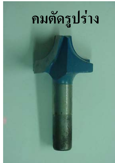
รูปที่ 3.6 แสดงไบมีดทั้งสแตนคาร์ไบด์ที่ใช้ทดลอง
