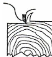
รูปที่ 2.18 การกັดไม้ตามรอยต่อไม้ [2]
