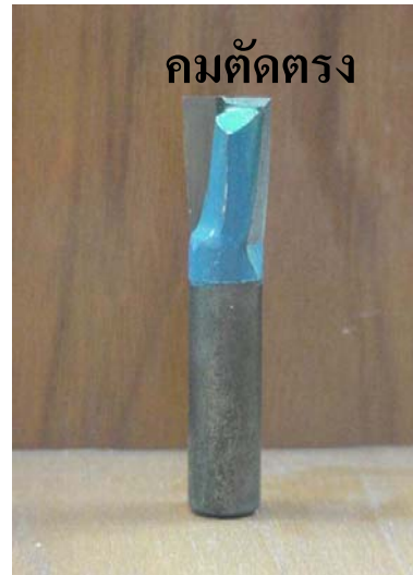
รูปที่ 3.6 แสดงไบมีดทั้งสแตนคาร์ไบด์ที่ใช้ทดลอง
