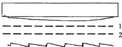
รูปที่ 28 การตรวจวัดหลังใบเลื่อยซึ่งมี ลักษณะเว้าเข้า (Concave back)
