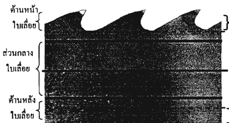
รูปที่ 36 ส่วนต่าง ๆ ของใบเลื่อย ด้านหน้า ด้านหลัง ส่วนกลาง และ ส่วนที่ไม่มีแรงค้ำ (tire)
