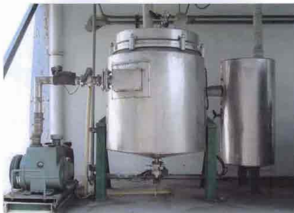
ภาพที่ 3.8 แสดงอัลตร้าซาวด์คอนเทนเนอร์ ซึ่งสามารถจับน้ำแข็งได้ 40 ลิตร ที่ความหนาของน้ำแข็ง 1 ซม.
