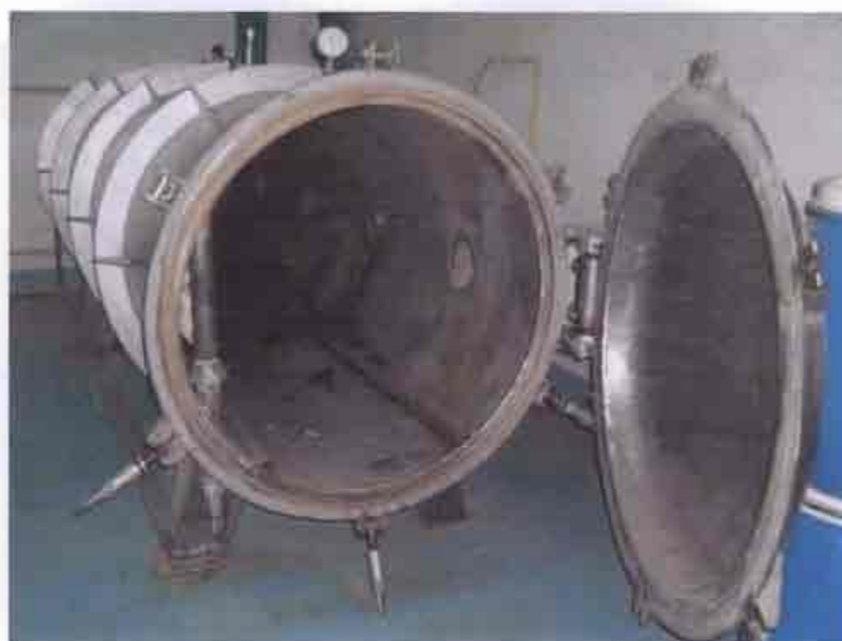
ภาพที่ 3.17 แสดงเครื่องอบแห้งแบบแช่เยือกแข็งบางส่วนที่จัดสร้างขึ้นในการผลิตไวตามินสำหรับสัตว์เศรษฐกิจ
