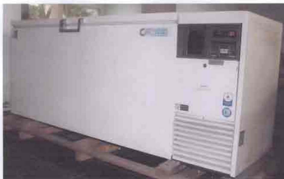
ภาพที่ 3.13 แสดงตู้แช่แข็งที่ใช้ในการทดลองสำหรับเครื่องอบแห้งแบบแช่เยือกแข็งบางส่วนในห้องทดลอง
