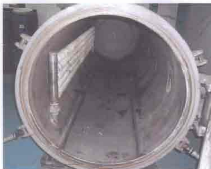
ภาพที่ 3.18 แสดงการติดตั้งแหล่งให้ความร้อนของเครื่องอบแห้งแบบแช่เยือกแข็งบางส่วนที่จัดสร้างขึ้นในการผลิตไวตามินสำหรับสัตว์เศรษฐกิจ
