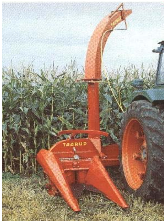
รูปที่ 3.1 แสดงเครื่องตัดและสับข้าวโพดที่ผลิตในประเทศเดนมาร์กแบบ single row harvester ใช้ใน ฟาร์มโคนมทั่วไป โดยใช้ต้นกำลังจากแทรกเตอร์ขนาดใหญ่
