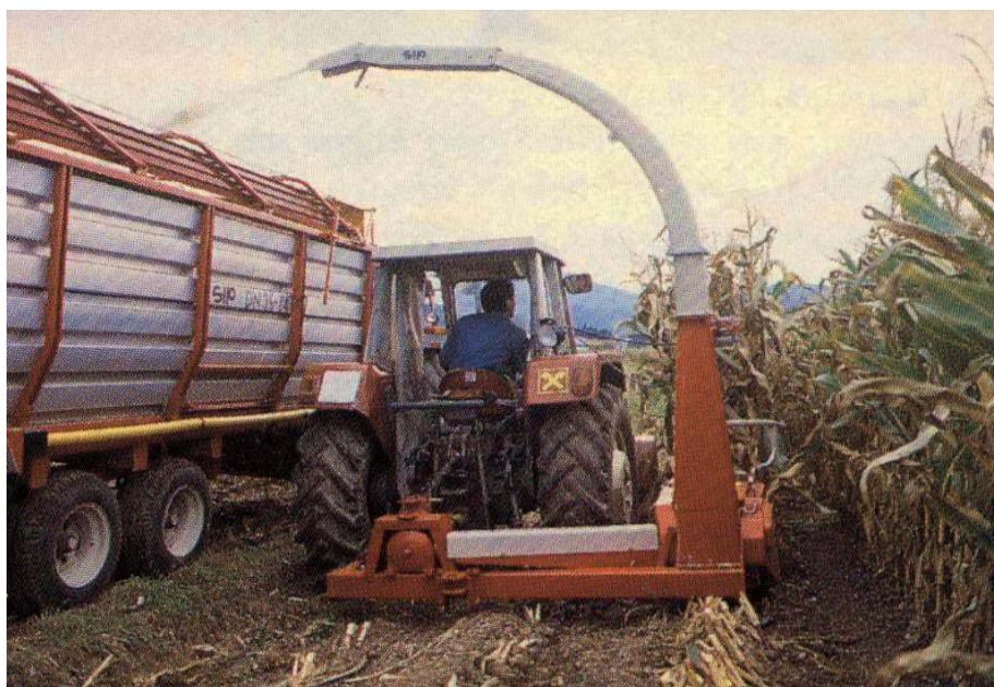
รูปที่ 3.3 แสดง chopper แบบตัด 2 จังหวะที่ผลิตในประเทศเดนมาร์กที่ใช้ในฟาร์มโคนมทั่วไป โดยใช้ต้นกำลังจากแทรคเตอร์ขนาดใหญ่
