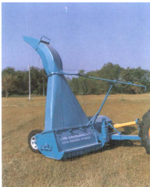
รูปที่ 3.4 แสดง chopper แบบตัดจังหวะเดียวที่ผลิตในประเทศ
