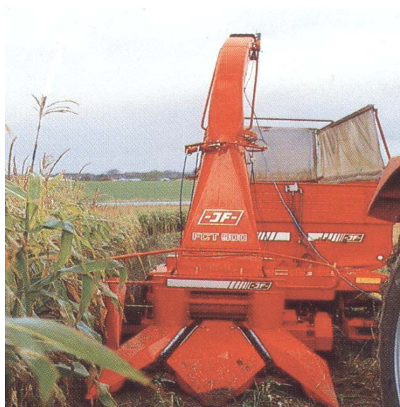
รูปที่ 3.2 แสดงเครื่องตัดและสับข้าวโพดที่ผลิตในประเทศเดนมาร์กแบบ double row harvester ใช้ในฟาร์มโคนมทั่วไป โดยใช้ต้นกำลังจากแทรกเตอร์ขนาดใหญ่
