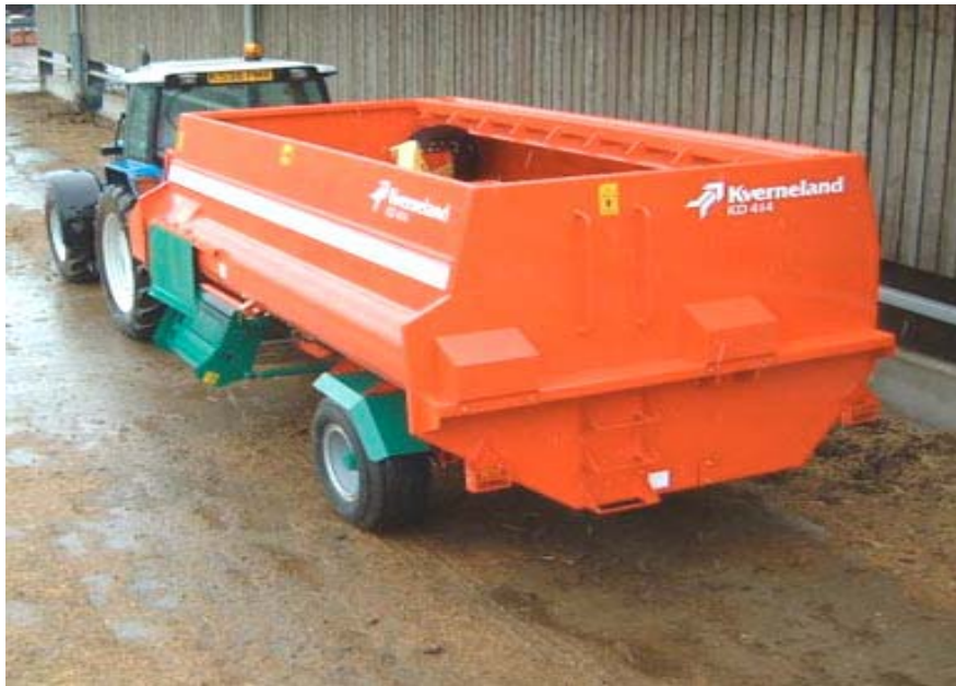
รูปที่ 3.8 แสดงเครื่องผสมและจ่ายอาหาร TMR ที่ใช้กำลังจากแทรกเตอร์ ขนาดใหญ่ของ บริษัทที่ผลิตในเดนมาร์ค
