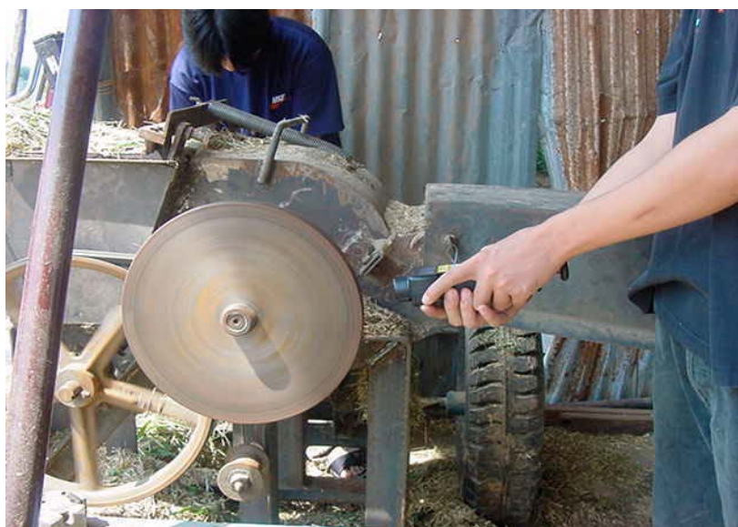
รูปที่ 5.5 แสดงการทดสอบเครื่องสับพืชอาหารหยาบแบบอยู่กับที่ที่ใช้กำลังจากมอเตอร์หรือเครื่องยนต์ที่สร้าง
