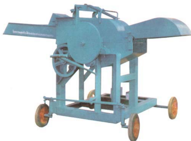
รูปที่ 3.5 แสดงเครื่องหั่นสับแบบอยู่กับที่ของโรงกลึงศุภชัย ใช้กำลังจากมอเตอร์ 3 แรงม้าขึ้นไป
