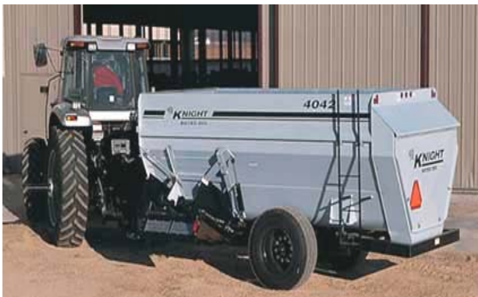
รูปที่ 3.7 แสดงเครื่องผสมและจ่ายอาหาร TMR ที่ใช้กำลังจากแทรกเตอร์ ขนาดใหญ่ของบริษัทที่ผลิตในอเมริกา
