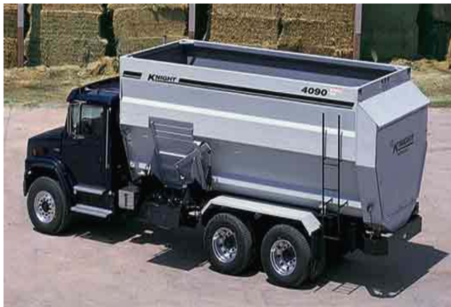
รูปที่ 3.9 แสดงเครื่องผสมและจ่ายอาหาร TMR แบบเทรลเลอร์ติดรถบรรทุก (Truck mount mixer)
