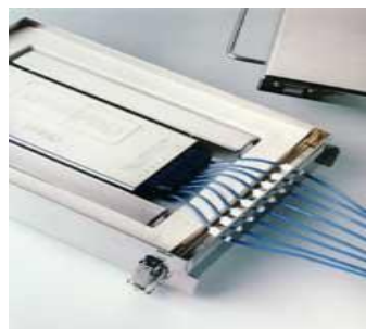
รูปที่ ๓.๕ แสดงการต่อ thermocouple เข้ากับ data logger
