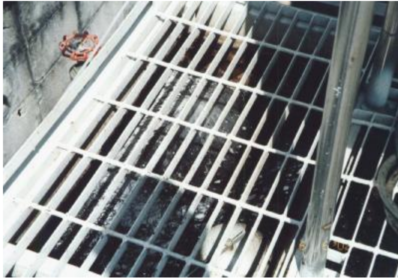
รูปที่ ๓.3 น้ำที่ผ่านการกรองตะกอน lacquer ก่อนกลับเข้าหอสเปรย์อีกครั้ง
