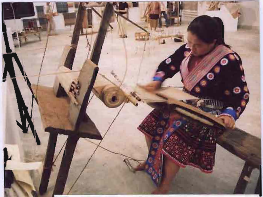
ชาวม้ง ดอขบขทอผ้าฝ้ายด้วยกี่เอวที่มีลักษณะเฉพาะ กลุ่มคน มีกระสวยพุ่ง ที่ออกแบบพิเศษให้สามารถกระทบ ด้ายพุ่งเหมือนฟืมทั่วไป (๒๕๔๔)
