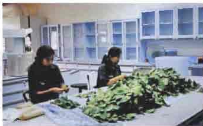
รูปที่ 4-3 การเตรียมตัวอย่างอ้างอิงพืช หลังจากเก็บใบมาจากสวนของเกษตรกรแล้ว นำมาตัดใบแก่จัดและถูกแมลงทำลายออก (ซ้าย) แล้วทำความสะอาดด้วยเครื่องอุตราสโนลด์ (ขวา)
