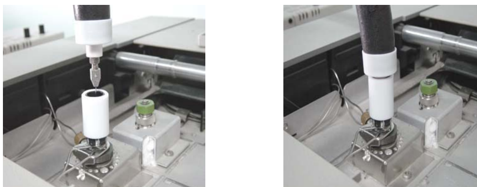
รูป 5.5 ท่อนำตัวอย่างของระบบ HS ซึ่งปลายท่อจะเป็นเข็มที่แทงผ่าน septum ของส่วนฉีดสารของระบบ GC เพื่อนำตัวอย่างเข้าวิเคราะห์โดยอัตโนมัติ
