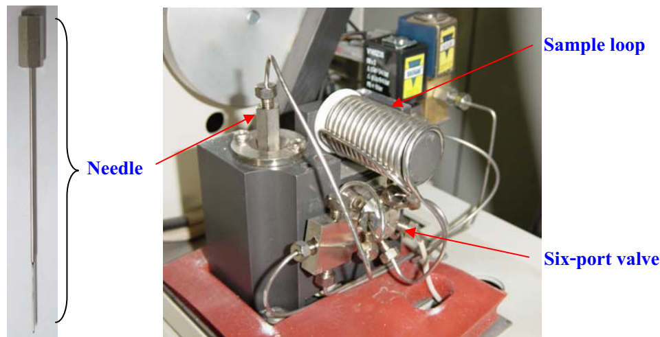
รูป 5.4 ส่วนนำไอระเหยของสารตัวอย่างซึ่งประกอบด้วย needle, six-port valve และ sample loop
