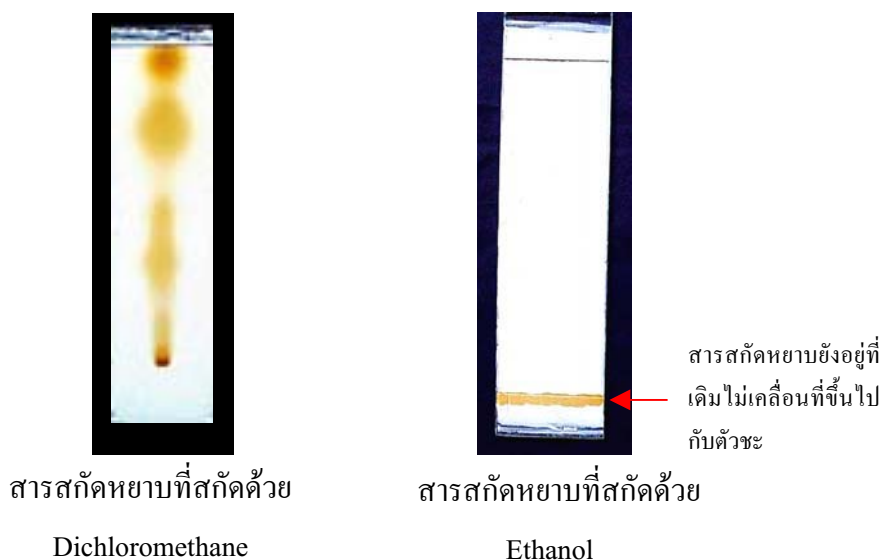
ภาพที่ 3.4 ผลการแยก Fraction ด้วยตัวทำละลายเคลื่อนที่ 80 : 20 : 1 บนระบบ Thin layer chromatography
