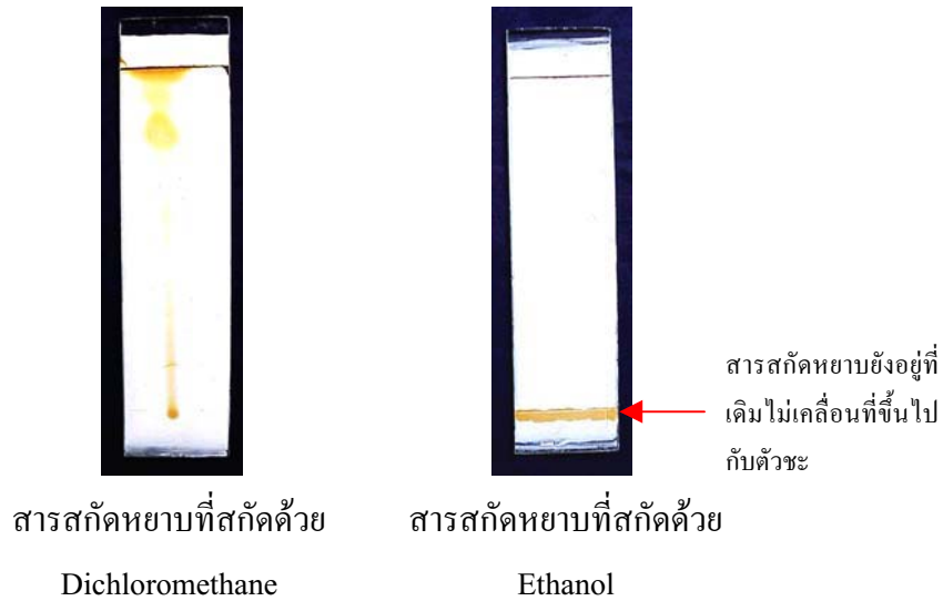
ภาพที่ 3.5 ผลการแยก Fraction ด้วยตัวทำละลายเคลื่อนที่ 60 : 40 : 1
