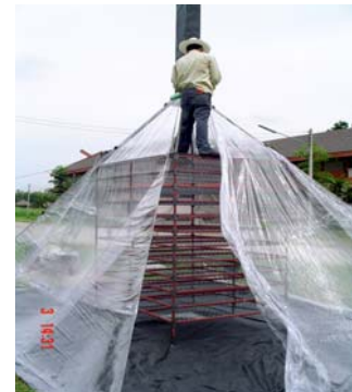
การบรรจุหญ้าสดใส่ในเครื่องอบและการประกอบกระโจม
