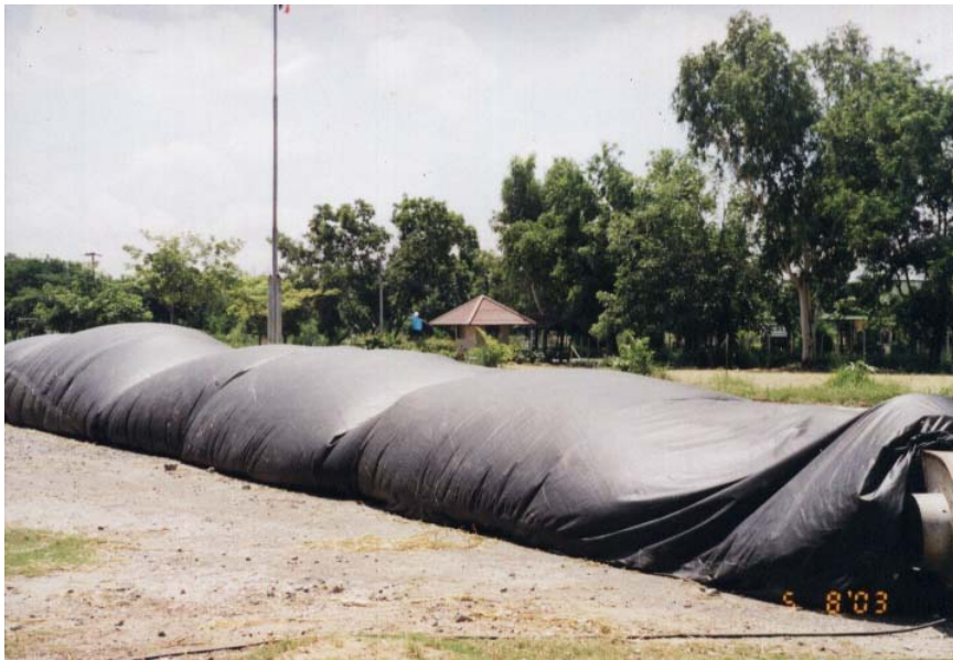
ภาพที่ 2 ลักษณะของพลาสติกพีวีซีสีดำที่ต่อด้วยกาวพิเศษ หุ้มกองหญ้าที่วางบนตะแกรง พร้อมทั้ง blower ที่พ่นลมเข้าไปในถุง
