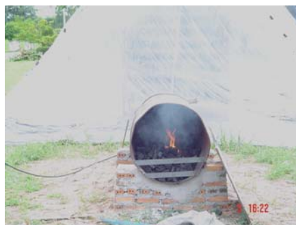
การใช้แหล่งความร้อนจากการเผาถ่าน ให้กับเครื่องอบ
