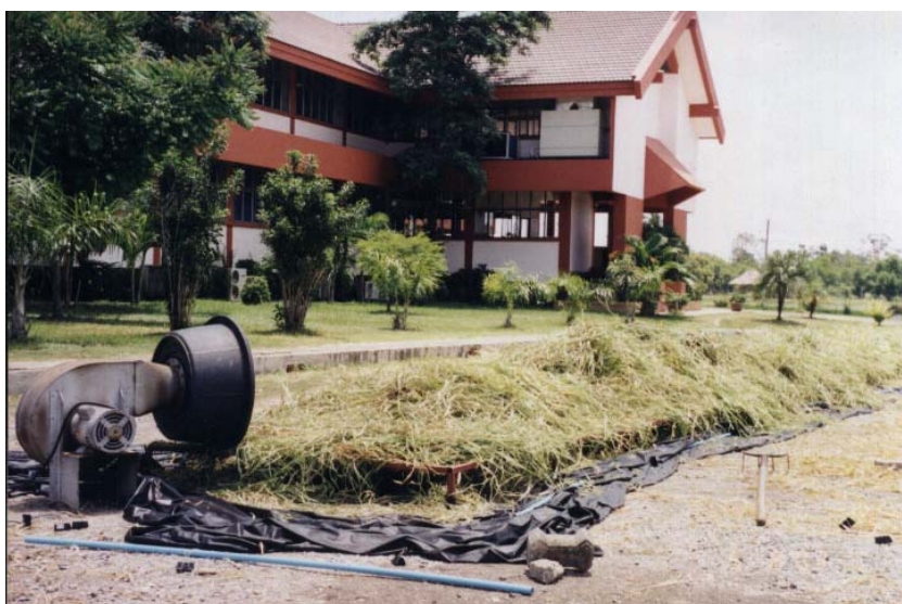
ภาพที่ 1 หญ้าที่ตัดแล้ว นำมาเกลี่ยบนตะแกรงพร้อมทั้ง blower ที่ทำหน้าที่ดูดอากาศจากภายนอก แล้วพ่นเป็นลมผ่านแนวหญ้า
