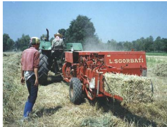
ลักษณะทางด้านหลังของเครื่องอัดฟ่อน เป็นทางออกของหญ้า
