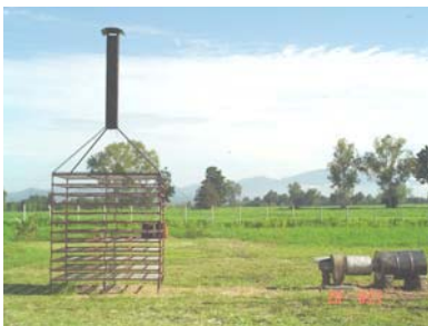
เครื่องอบแบบกระโจมปิรามิด พร้อมเตาให้ความร้อน
