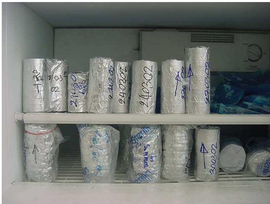
รูปที่ 2-10 กระดาศกรงที่ผ่านการเก็บตัวอย่างและซังน้ำหนักถูกเก็บภายในตู้แช่ที่อุณหภูมิประมาณ 4 องศาเซลเซียส
