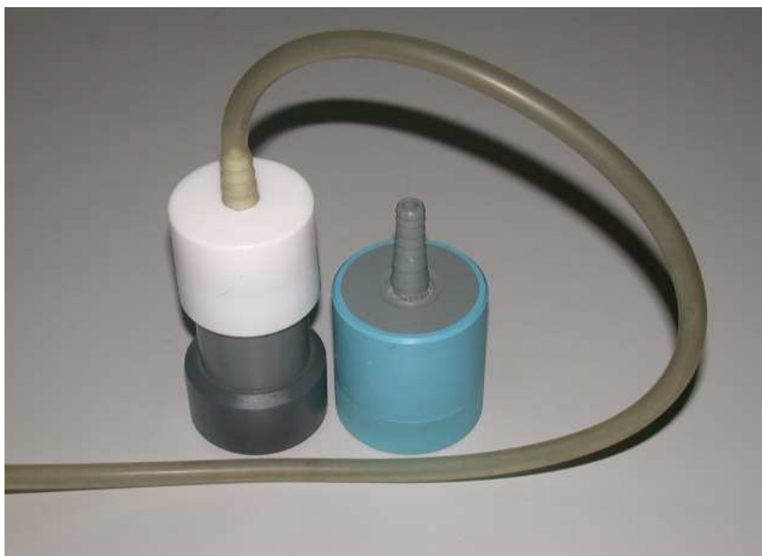
รูปที่ 2-4 ชุดหัวสอบเทียบอัตราการไหลของอากาศสำหรับเครื่อง MiniVol™ ที่ทำขึ้นใช้เองโดย วศ. เมื่อใช้ร่วมกับเครื่องสอบเทียบอัตราการไหลของอากาศ Gilibrator™
