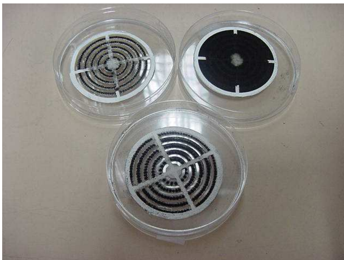
รูปที่ 3-5. ตัวอย่างของฝุ่นแยกขนาดที่ได้จากการเก็บตัวอย่างการเผาไหม้เชื้อเพลิง (น้ำมันเตา) รวมทั้งกระดาศกรงที่เป็น backup ในชั้นสุดท้าย
