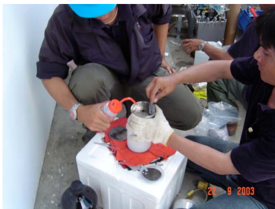
รูปที่ 9.19 การเตรียมอุปกรณ์เก็บตัวอย่างอากาศ
