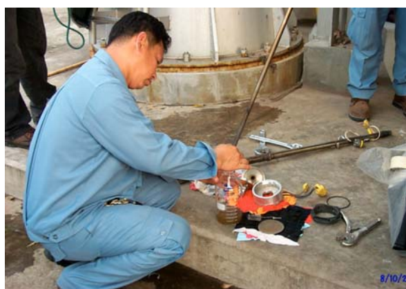
รูปที่ 11.20 การเก็บตัวอย่างฝุ่นละอองที่ได้ไปวิเคราะห์ยังห้องปฏิบัติการ
