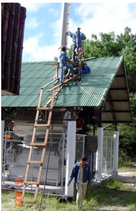
รูปที่ 8.16 การทดสอบสมรรถนะเตาเผาขยะมูลฝอยชุมชน
