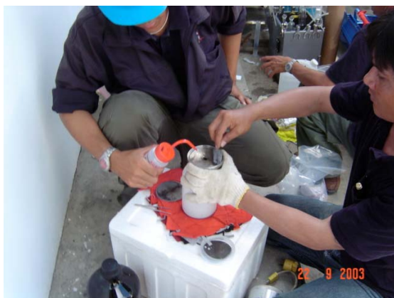
รูปที่ 9.19 การเตรียมอุปกรณ์เก็บตัวอย่างอากาศ
