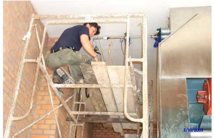
รูปที่ 10.27 การเตรียมอุปกรณ์เก็บตัวอย่างอากาศ
