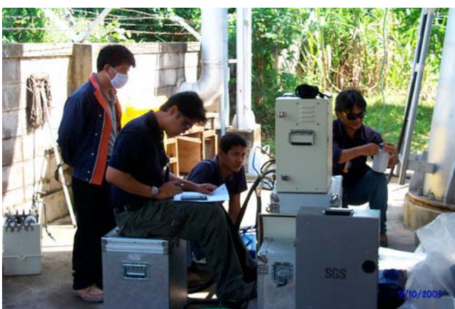
รูปที่ 11.19 การเตรียมอุปกรณ์เก็บตัวอย่างอากาศ
