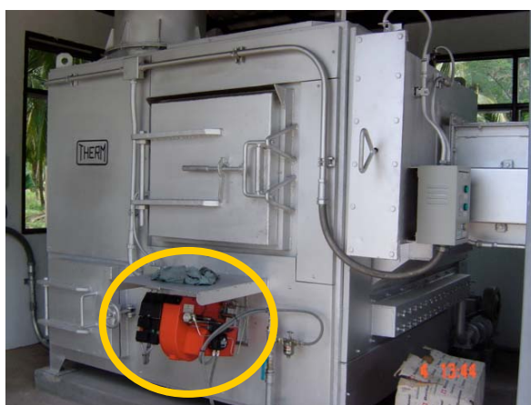
รูปที่ 9.4 หัวเผาของห้องเผาไหม้ที่ 1 (101kW)
