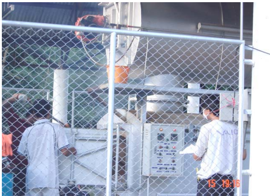
รูปที่ 8.16 การทดสอบสมรรถนะเตาเผาขยะมูลฝอยชุมชน
