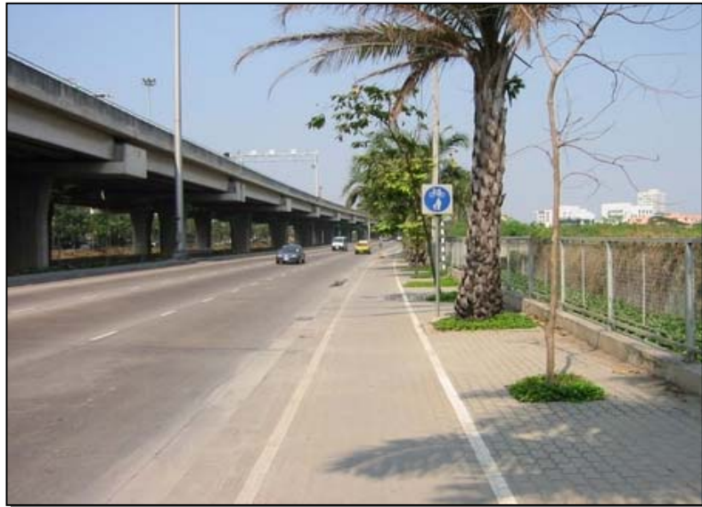
รูปที่ 4.12 ทางจักรยานร่วมกับทางเท้าขนาดความกว้าง 1.5 เมตร
