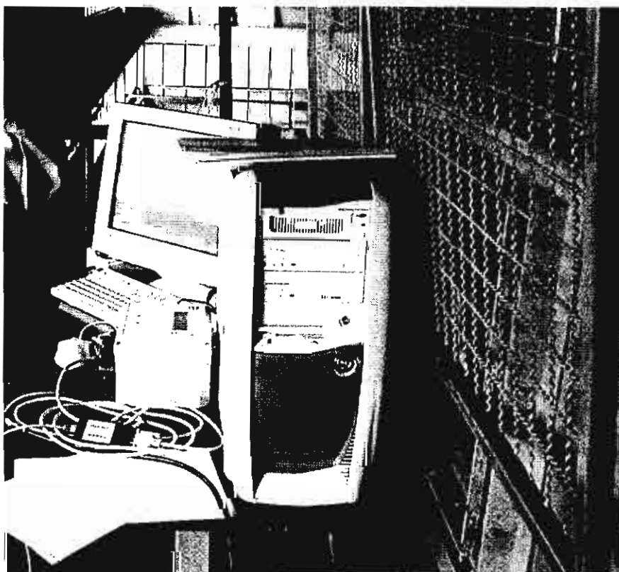
รูปที่ 4.18 การติดตั้งเครื่องคอมพิวเตอร์เพื่อวัดค่าออกซิเจนละลายที่ถังทดสอบ 1.5x2x5 เมตร
