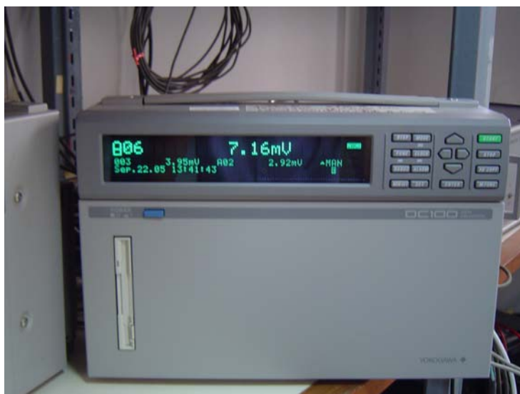
รูปที่ 3.88 แสดงเครื่องบันทึกข้อมูลเชิงตัวเลข (data logger) ของ Yokogawa รุ่น DC100 ที่ใช้บันทึกความเข้มรังสีอุลตราไวโอเลตบี
