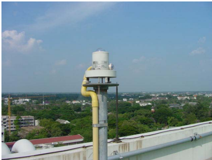
รูปที่ 3.92 แสดงเครื่องวัดความเข้มรังสีอุลตราไวโอเลตบี (Absolute UV-B) ที่สถานีนครปฐม
