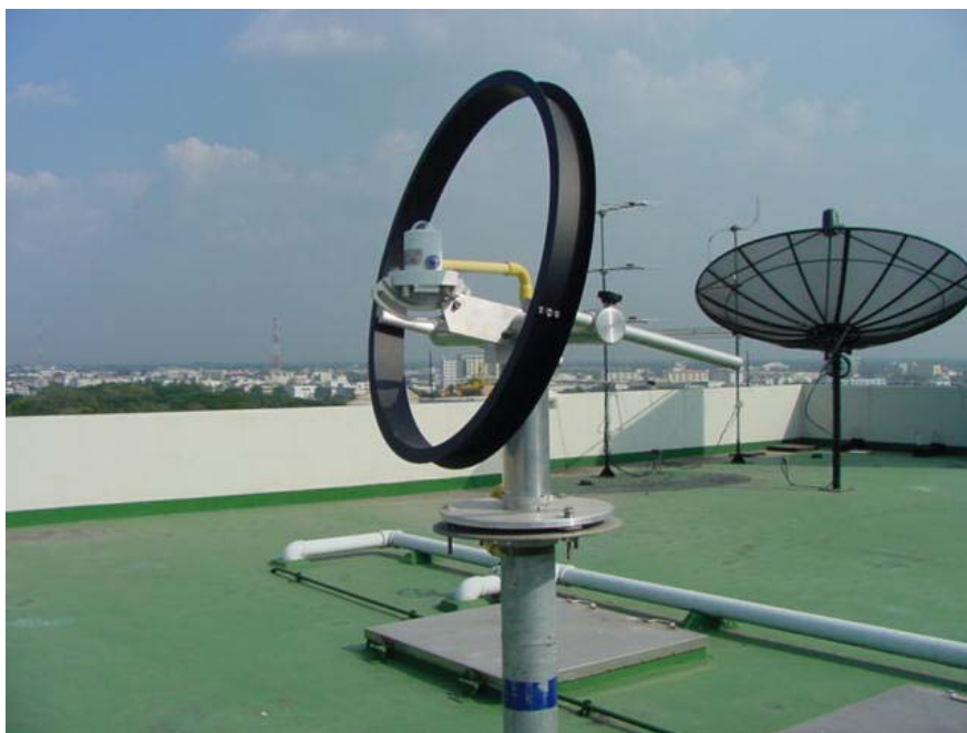
รูปที่ 3.93 แสดงเครื่องวัดความเข้มรังสีอุลตราไวโอเลตบีซึ่งติดตั้งพร้อมวงแหวนบังรังสีตรงที่สถานีนครปฐม ซึ่งต่อมาภายหลังได้นำไปติดตั้งที่สถานีเชียงใหม่
