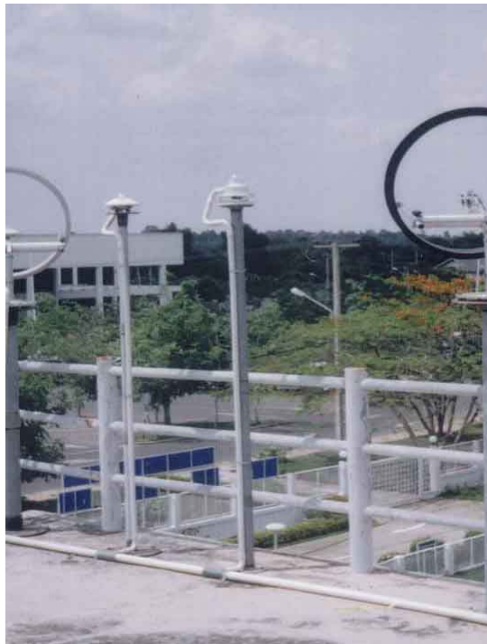
รูปที่ 3.7 แสดงภาพเครื่องวัดความเข้มรังสีอุตสาหกรรมไอโอเลตที่มีผลต่อผิวหนังมนุษย์ที่สถานีอุบลราชธานี
