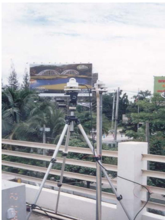
รูปที่ 3.15 แสดงการสอบเทียบเครื่องวัดความเข้มรังสีอุลตราไวโอเลตที่มีผลต่อผิวหนังมนุษย์ ที่สถานีเชียงใหม่
