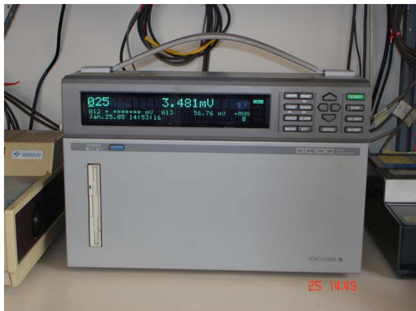
รูปที่ 3.75 แสดงเครื่องบันทึกข้อมูลเชิงตัวเลข (data logger) ของ Yokogawa รุ่น DC100 ที่ใช้บันทึกข้อมูล TUV
