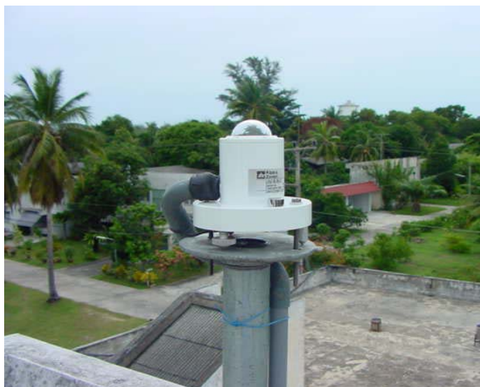
รูปที่ 3.94 แสดงเครื่องวัดความเข้มรังสีอุลตราไวโอเลตบี (Absolute UV-B) ที่สถานีสงขลา
