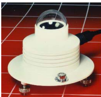
รูปที่ 3.14 แสดงเครื่องวัดความเข้มรังสีอัลตราไวโอเล็ตที่จัดซื้อเพิ่มเติม เพื่อใช้เป็นเครื่องวัดมาตรฐาน
