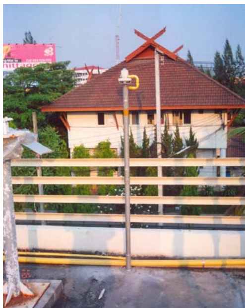
รูปที่ 3.91 แสดงเครื่องวัดความเข้มรังสีอุลตราไวโอเลตบี (Absolute UV-B) ที่สถานีเชียงใหม่
