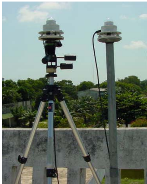
รูปที่ 3.18 แสดงการสอบเทียบเครื่องวัดความเข้มรังสีอุลตราไวโอเลตที่มีผลต่อผิวหนังมนุษย์ ที่สถานีสงขลา
