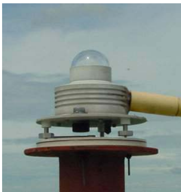
รูปที่ 2.17 แสดงลักษณะของเครื่องวัด erythral UV ของบริษัท Solar Light
