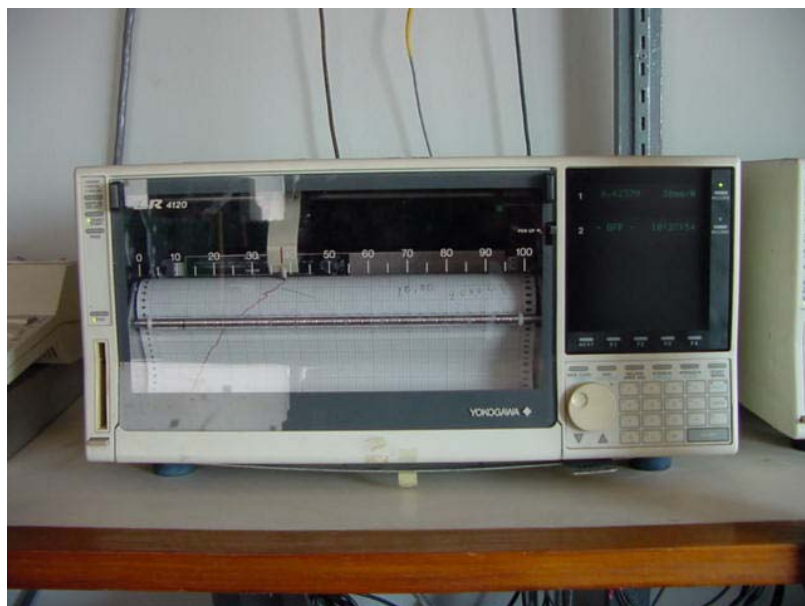
รูปที่ 3.87 แสดงเครื่องบันทึกสัญญาณลงบนกระดาษกราฟของ Yokogawa รุ่น LR4120
