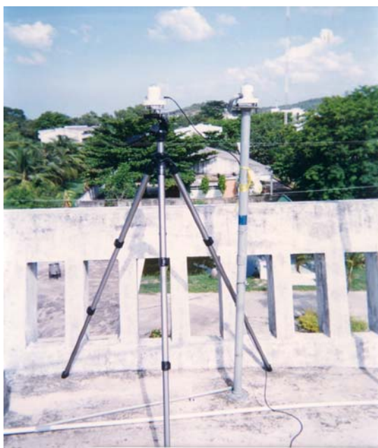
รูปที่ 3.98 แสดงการสอบเทียบเครื่องวัดความเข้มรังสีอุลตราไวโอเลตบีที่สถานีสงขลา เมื่อวันที่ 14 มีนาคม 2548
