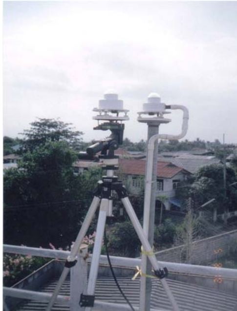
รูปที่ 3.16 แสดงการสอบเทียบเครื่องวัดความเข้มรังสีอุลตราไวโอเลตที่มีผลต่อผิวหนังมนุษย์ ที่สถานีอุบลราชธานี
