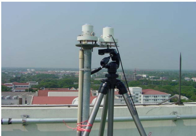
รูปที่ 3.95 แสดงการสอบเทียบเครื่องวัดความเข้มรังสีอัลตราไวโอเลตบีที่สถานีนครปฐม
