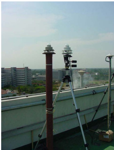
รูปที่ 3.17 แสดงการสอบเทียบเครื่องวัดความเข้มรังสีอุลตราไวโอเลตที่มีผลต่อผิวหนังมนุษย์ ที่สถานีนครปฐม
