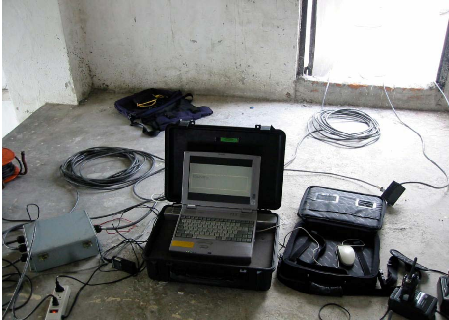
รูปที่ 2 เครื่องบันทึกสัญญาณระบบดิจิทัลแบบพกพา และ Notebook Computer ของอุปกรณ์วัดความเร่งของการสั่นสะเทือน
