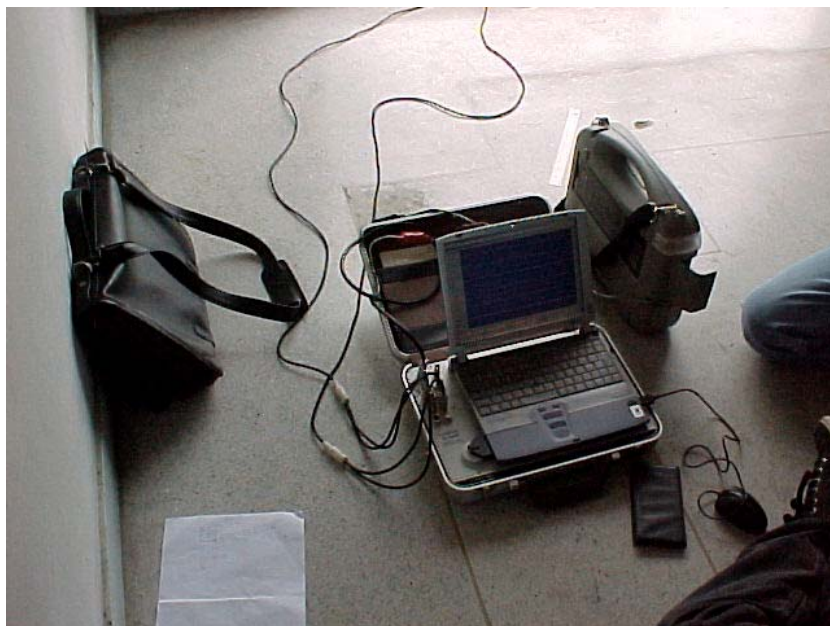
รูปที่ 4 เครื่องบันทึกสัญญาณระบบดิจิทัลระบบพกพา พร้อม Note book 1 ชุด และแบตเตอรี่สำหรับอุปกรณ์วัดความเร็วของการสั่นสะเทือน
