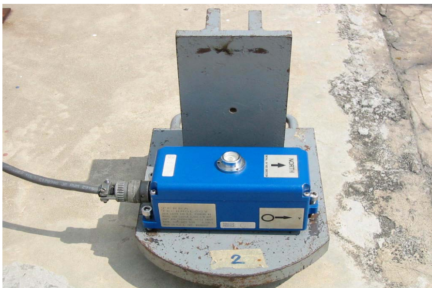
รูปที่ 1 หัววัดการวัดความเร่งการสั่นสะเทือน
