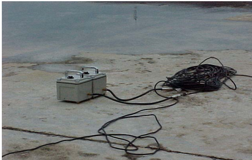
รูปที่ 3 หัววัดความเร็วการสั่นสะเทือน จำนวน 2 ชุด
