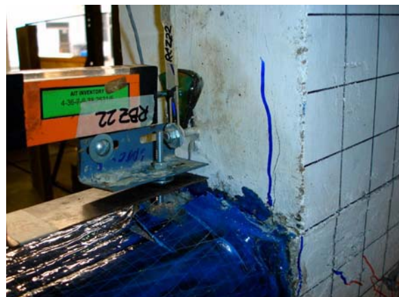
รอบการเคลื่อนตัว \pm 5.00 % (แผ่น FRP ด้านบน ขาด)
