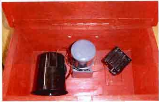
รูปที่ 8-24 การสาธิตวิธีติดตั้งลูกลอยเตือนภัยจากชาวบ้าน
