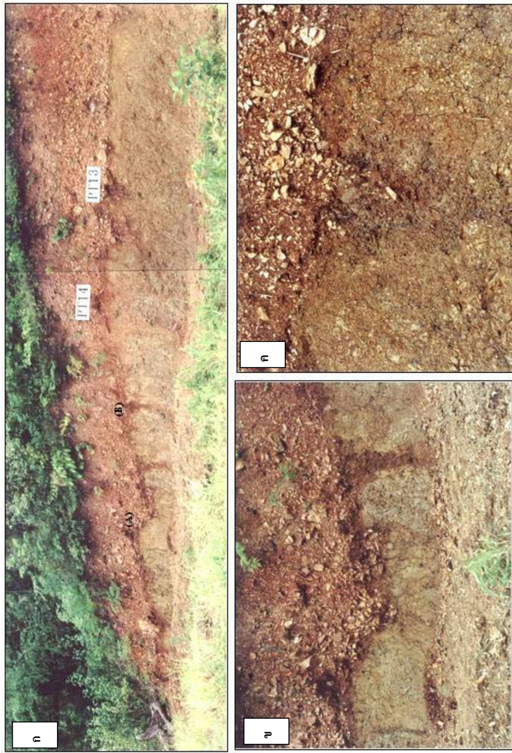
รูป 5.8 ก. ผนังร่องสำรวจบ้านผาตะวันตก 2 แสดงลักษณะของชั้นกรวด วางตัวอยู่บนหินดินดาน ข. ภาพขยายบริเวณ a แสดงลักษณะของชั้นกรวดที่มีลักษณะเป็นลิ้นในหินชั้นฐาน ค. ภาพขยายบริเวณ b แสดงลักษณะของชั้นกรวดที่มีลักษณะเป็นลิ้นในหินชั้นฐาน
