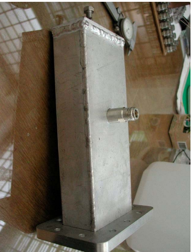
รูปที่ 4.11 แสดง coupler ด้านแม่เหล็กกำเนิด เพื่อส่งไมโครเวฟผ่านสายโคแอกเซียลให้แก่หัวจ่ายไดออดน
