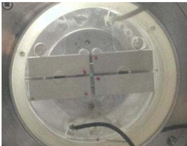
รูปที่ 3.7 แสดงแม่เหล็กไดโพลคู่ที่ติดตั้งใหม่ ให้มี path length เพียง 1 ซม. เพื่อเบนบีมอาร์กอน
