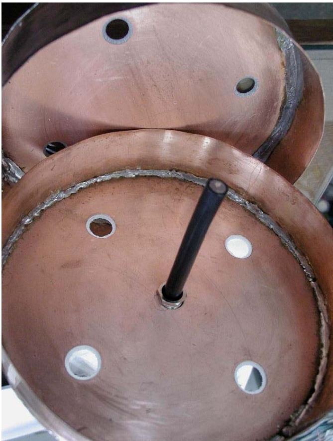
รูปที่ 4.10 ไมค์ดูลหัวจ่ายเพื่อทดสอบแม่ทึงของไมโครเวฟ ใช้แกนสายโคแอกเซียลเป็น antenna
