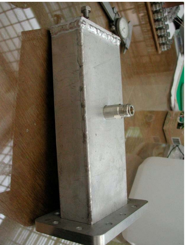
รูปที่ 4.11 แสดง coupler ด้านแม่เหล็กกำเนิด เพื่อส่งไมโครเวฟผ่านสายโคแอกเซียลให้แก่หัวจ่ายไออน
