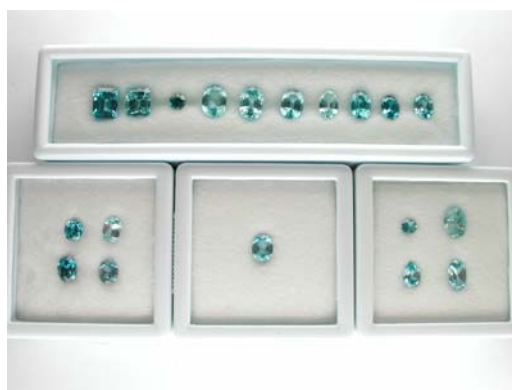
เซอร์คอนสีฟ้าหลังเผาที่สภาวะบรรยากาศรีดักชัน R 1000/300/2
