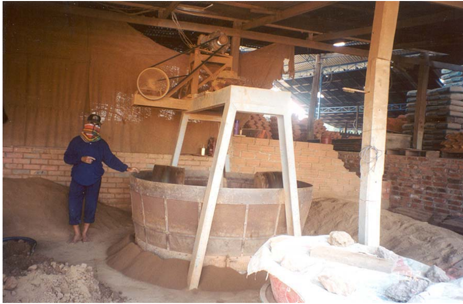
รูปที่ 9 การบดดินอ่างทองให้ละเอียดเพื่อใช้ในการขึ้นรูปผลิตภัณฑ์
