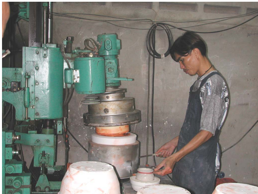
รูปที่ 68 กำลังขึ้นรูปกระถางเซรามิกน้ำหนักเบาด้วย Roller machine
