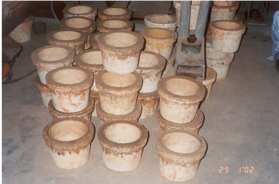
รูปที่ 25 โมลด์ (Mold) ปูนพลาสติกที่ใช้ในการขึ้นรูปกระถางขนาด 6 นิ้ว
