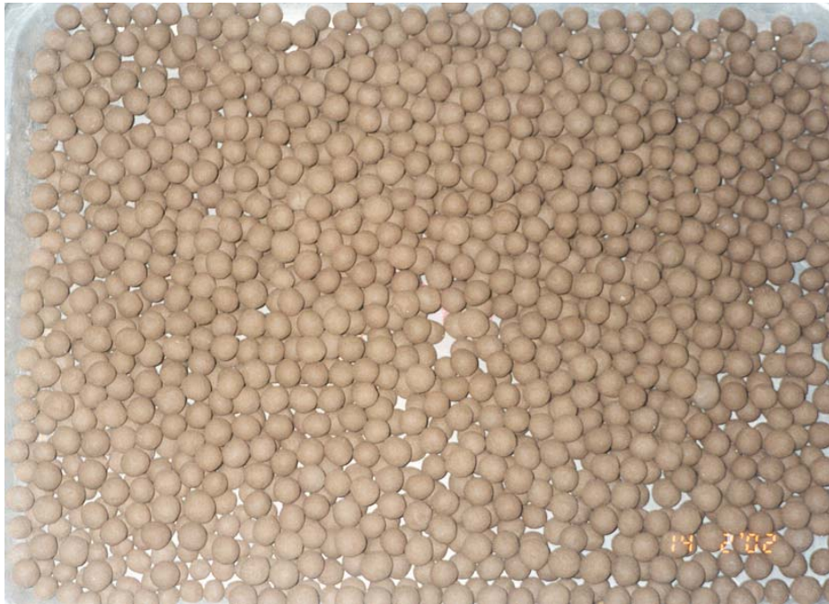
รูปที่ 31 เม็ดเซรามิกน้ำหนักเบาทรงกลมก่อนเผา
