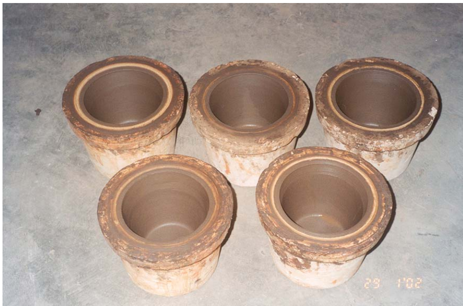
รูปที่ 28 กระถางดินอ่างทอง + ขี้เลื่อยในโมลด์ปูนปลาสเตอร์ ทั้งไว้ประมาณ ครึ่งชั่วโมงจึงนำเอากระถางออกจากโมลด์ได้
