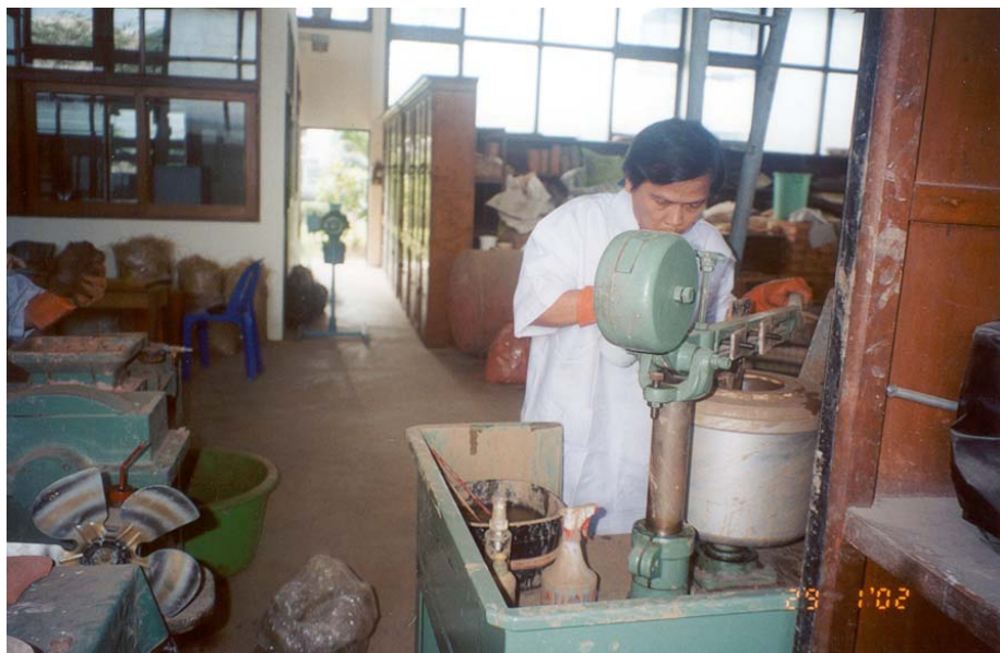
รูปที่ 26 การขึ้นรูปกระถางขนาด 6 นิ้ว ด้วยเครื่องจักรไฟฟ้า
