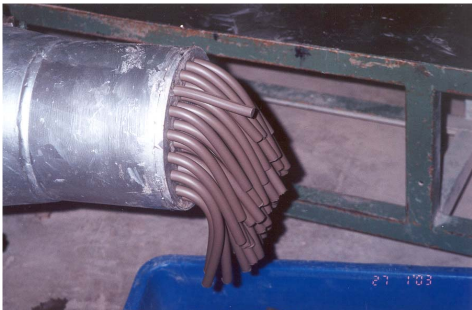
รูปที่ 74 ถ้าไม่ตัดให้สั้นดินขาด เครื่องรีดดินจะรีดออกมายาว
