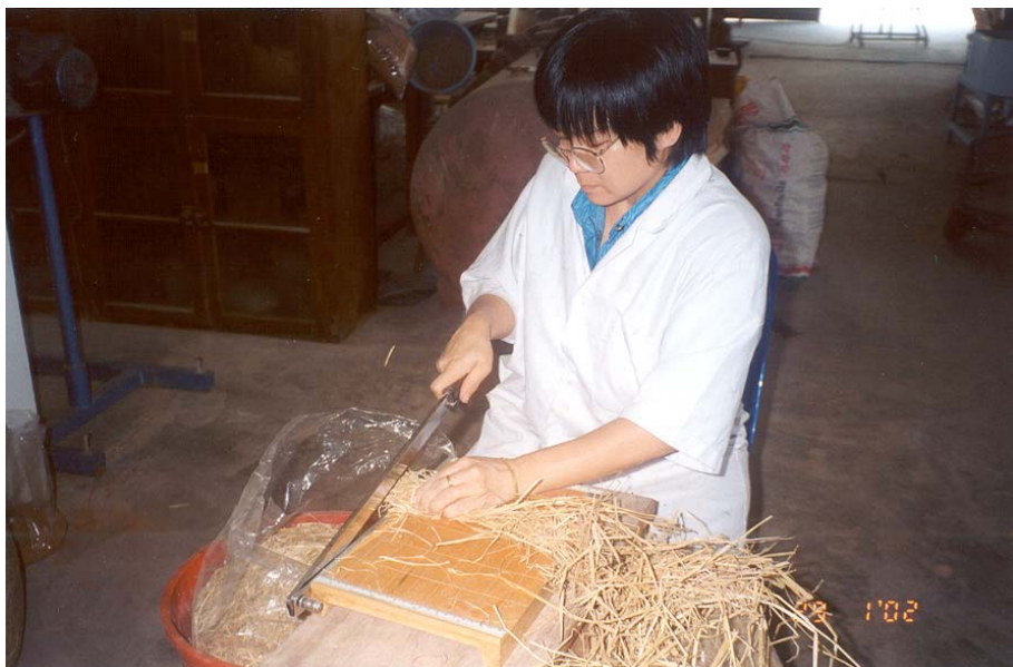
รูปที่ 14 การหั่นฟางข้าวให้มีขนาดเล็ก ก่อนจะนำไปบดให้ละเอียดอีกครั้งหนึ่ง
