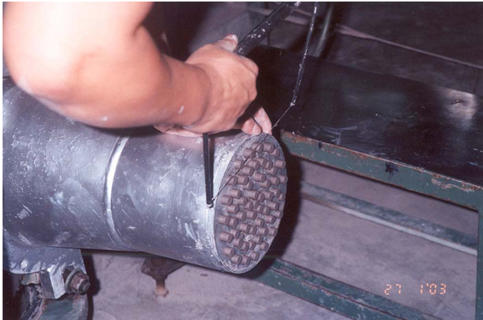
รูปที่ 73 เมื่อเครื่องมือรีดดิน รีดดินออกมาได้ขนาดตามที่ต้องการ ก็ตัดให้ขาดออกมาเป็นเม็ด
