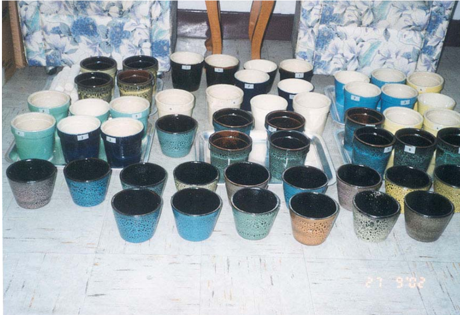
รูปที่ 33 ผลิตภัณฑ์เซรามิกน้ำหนักเบาขนาด 6 นิ้ว ชนิดมีขอบและไม่มีขอบ เคลือบด้วยสีเซรามิกหลายสี สำหรับสวมกระถางเซรามิกน้ำหนักเบา ขนาด 4 นิ้ว ไม่เคลือบ
