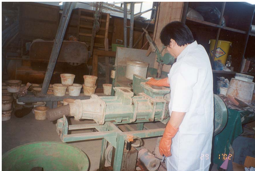
รูปที่ 22 นำนารีดให้เนื้อดินเข้ากันดีขึ้น ด้วยเครื่องรีดดิน (Extruder) 5 ครั้ง
