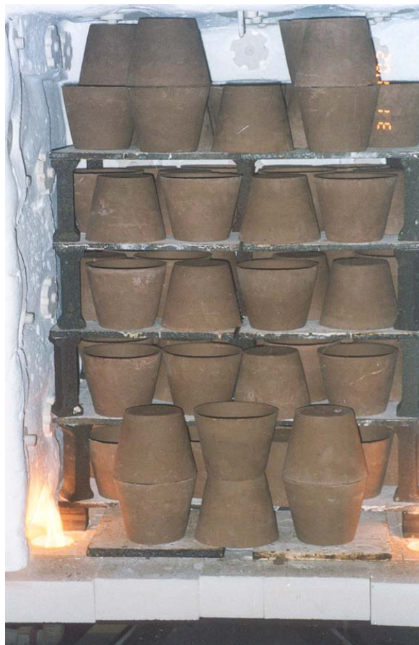
รูปที่ 30 เรียงกระถางดินอ่างทอง + จี้เลื่อยในเตาแก๊ส แล้วเผาที่อุณหภูมิ 950 องศาเซลเซียส
