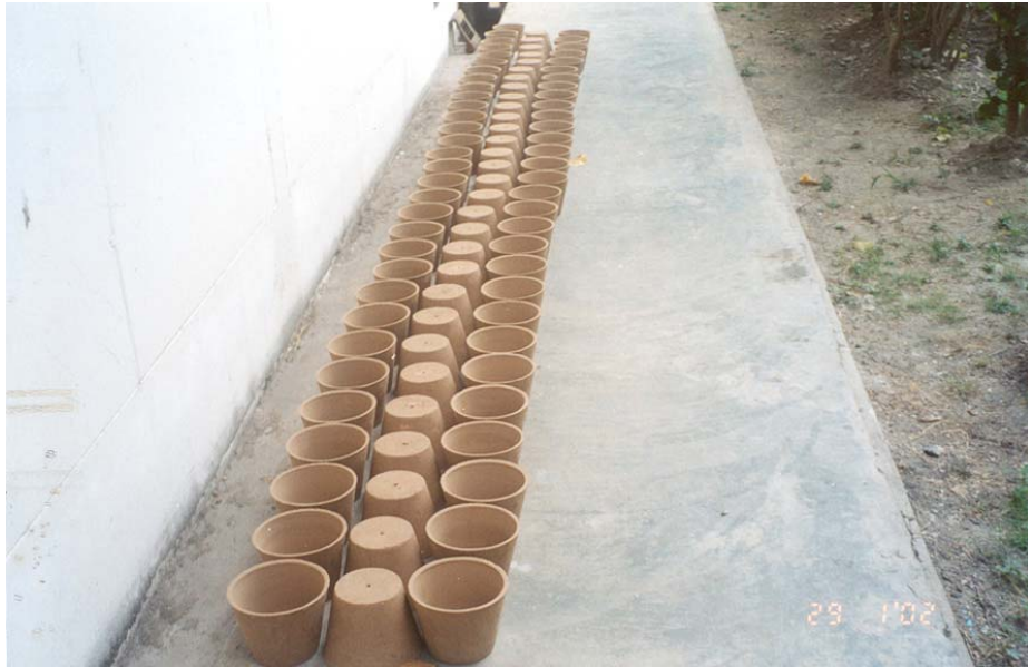
รูปที่ 29 กระถางดินอ่างทอง + จี้เลื่อยฝึกลมให้แห้งก่อนนำไปเผา
