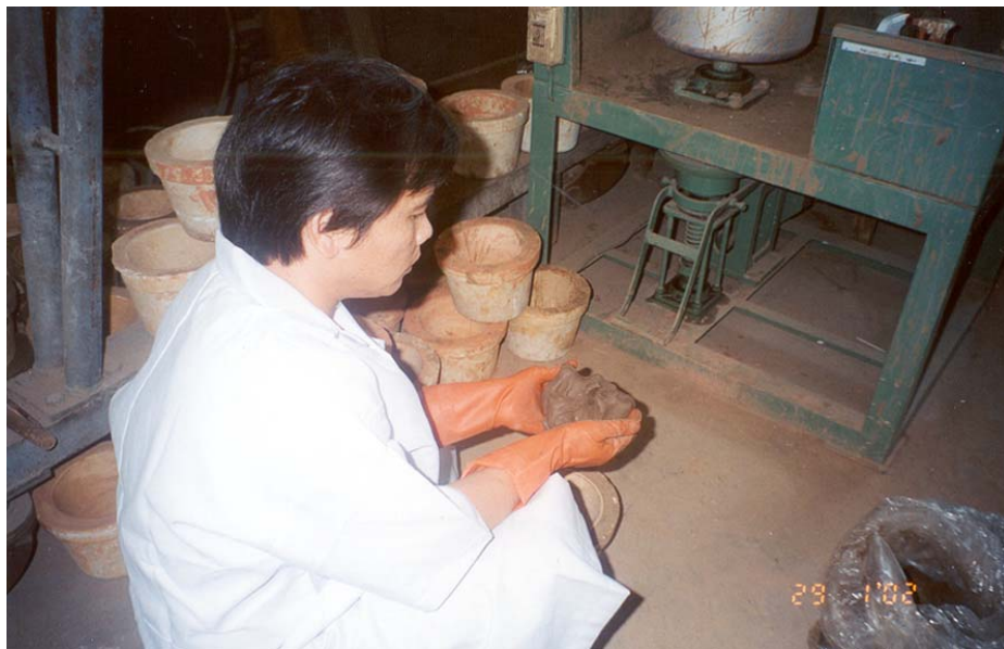
รูปที่ 24 นำมาปั้นเป็นก้อนกลมให้พอเหมาะสำหรับการขึ้นรูปด้วยเครื่อง จิกเกอร์ (Jigger)
