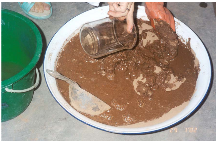
รูปที่ 20 เทน้ำสะอาดใส่ในส่วนผสมของซีเมนต์และดินอ่างทองคลุกเคล้าให้เป็นเนื้อเดียวกัน
