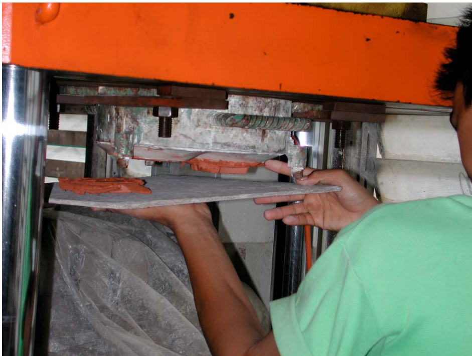
รูปที่ 76 แสดงการขึ้นรูปแผ่นเซรามิกน้ำหนักเบารูปหัวใจ ในระบบอุตสาหกรรม
