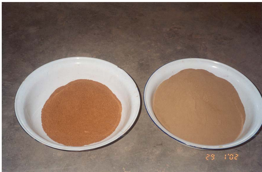
รูปที่ 18 จีเลื้อยบดละเอียด (ซ้ายมือ) และดินอ่างทอง (ขวามือ) ที่ชั่งตามอัตราส่วน ดิน : จีเลื้อย = 89 : 11
