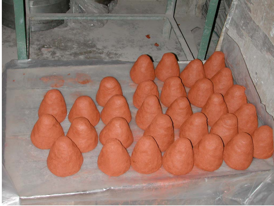
รูปที่ 67 ก่อนดินเตรียมสำหรับขึ้นรูปกระถางเซรามิกน้ำหนักเบา ขนาด 6 นิ้ว ด้วย roller machine
