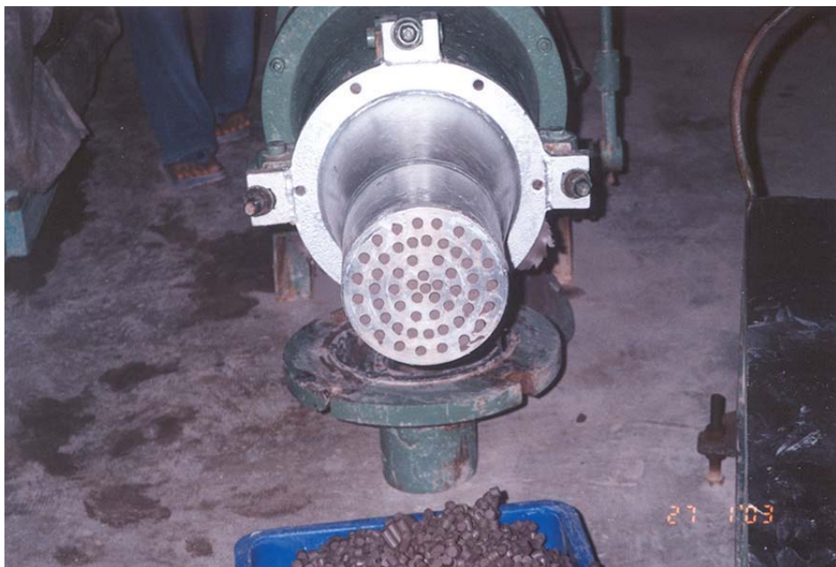
รูปที่ 72 ส่วนหัวของเครื่องรีดดินที่มีรังผึ้ง stainless ปิด ขนาดของรูกำหนดตามขนาดของเม็ดเซรามิกน้ำหนักเบา
