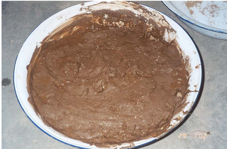
รูปที่ 21 เนื้อดินอ่างทอง + จีเลื้อยที่ผสมเข้ากันดีแล้ว
