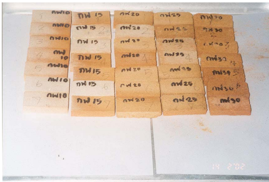
รูปที่ 10 แสดงดินกำแพงเพชรผสมฟางข้าวในอัตราส่วนต่างๆที่นำมาทำขึ้นทดสอบ เผาที่อุณหภูมิ 1230 องศาเซลเซียส
