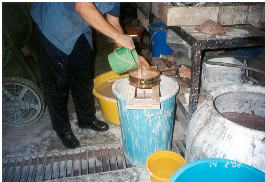
รูปที่ 6 ดินก้ำแพงเพชรซึ่งผ่านการบดในหม้อบดแล้วนำมาร่อนผ่านตะแกรงขนาด 60 เมช
